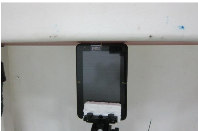
Edge 2 with Phantom 0 cm Gap
