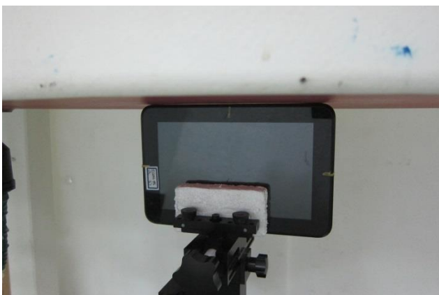
Edge 3 with Phantom 0 cm Gap
