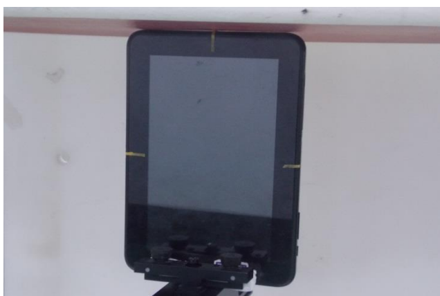
Edge 4 with Phantom 0 cm Gap
