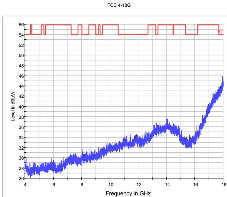
Fig.75. Radiated emission:  $\pi/4$  DQPSK, Channel 39, 4 GHz - 18 GHz
