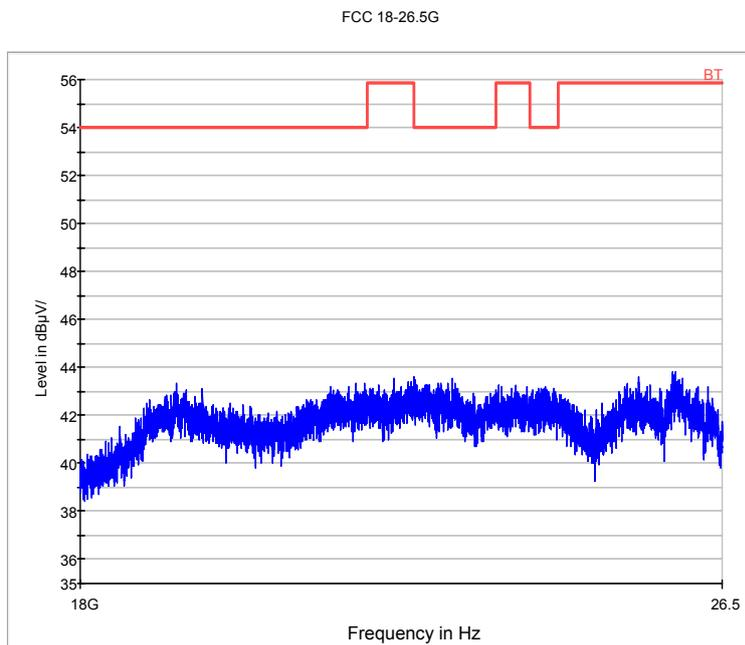
Fig.81. Radiated emission:  $\pi/4$  DQPSK, 18 GHz - 26 GHz
