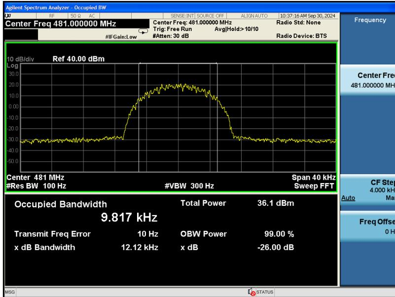
DL\_H-DQPSK\_MCH\_Output\_3dB above AGC
