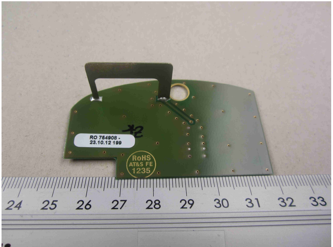
130857_18.JPG: BTAB-2450 Antenna top view
