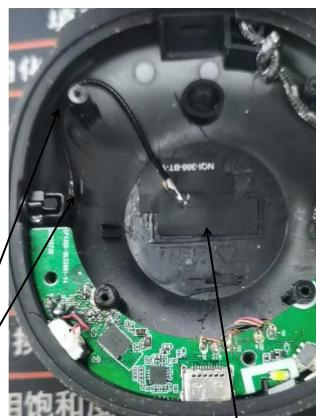
同轴线沿螺柱外放置，卡扣卡住线
