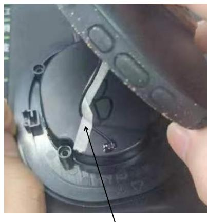
喇叭线出线处需贴胶布固定在图中位置
