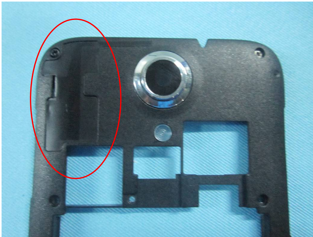
Bluetooth / BLE / WIFI Antenna View
