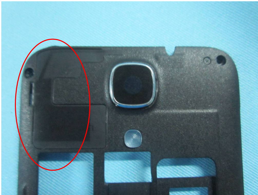
Bluetooth / BLE / WIFI Antenna View
