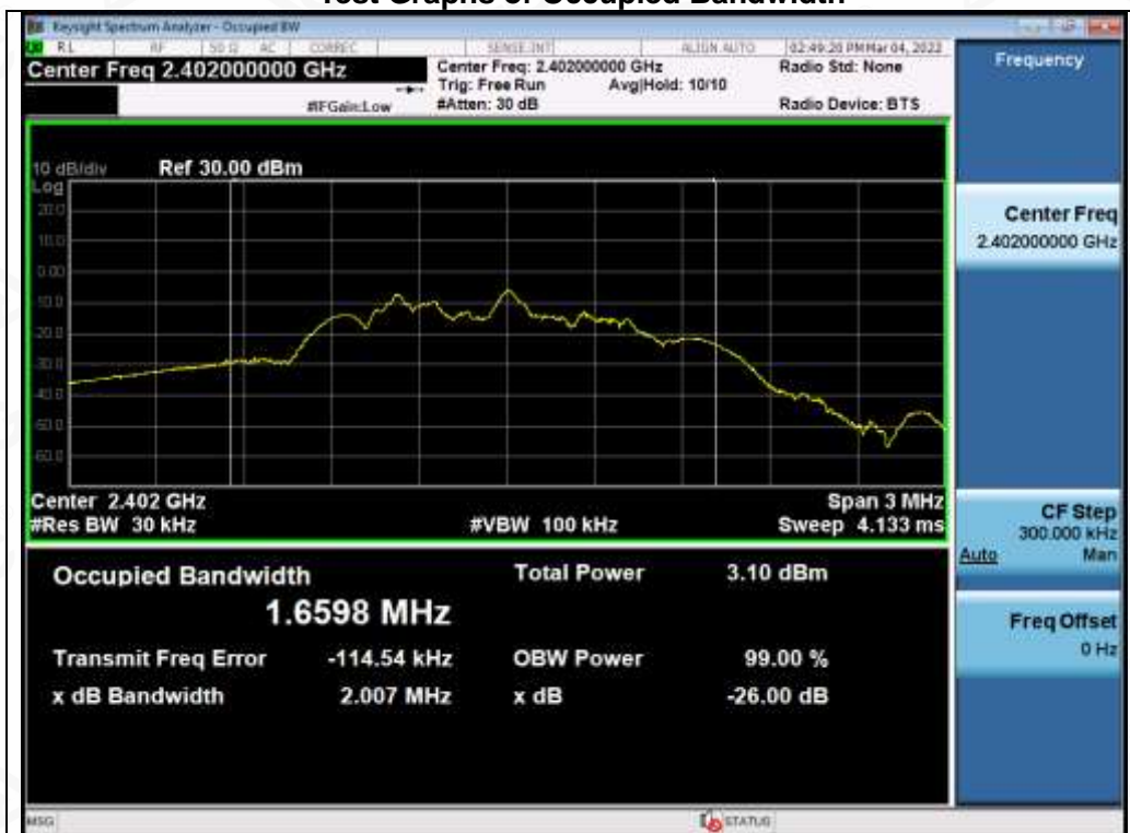
Test_Graph_2.4GHz_ANT1_2402_GFSK_OBW
