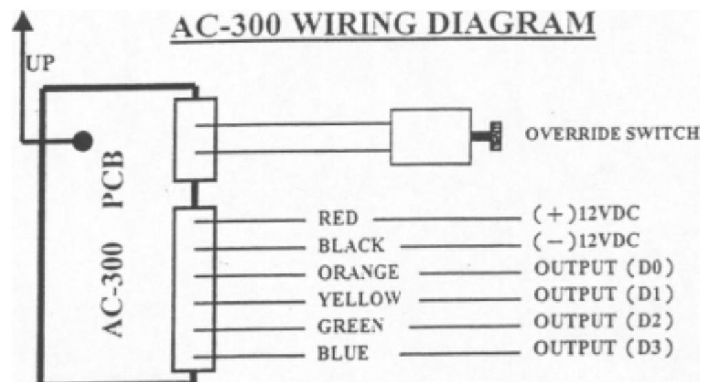
※NOTE : FOR AN EFFECTIVE RECEIVER, YOU HAVE TO STRAIGHTEN UPWARD THE ANTENNA AND FIX.
