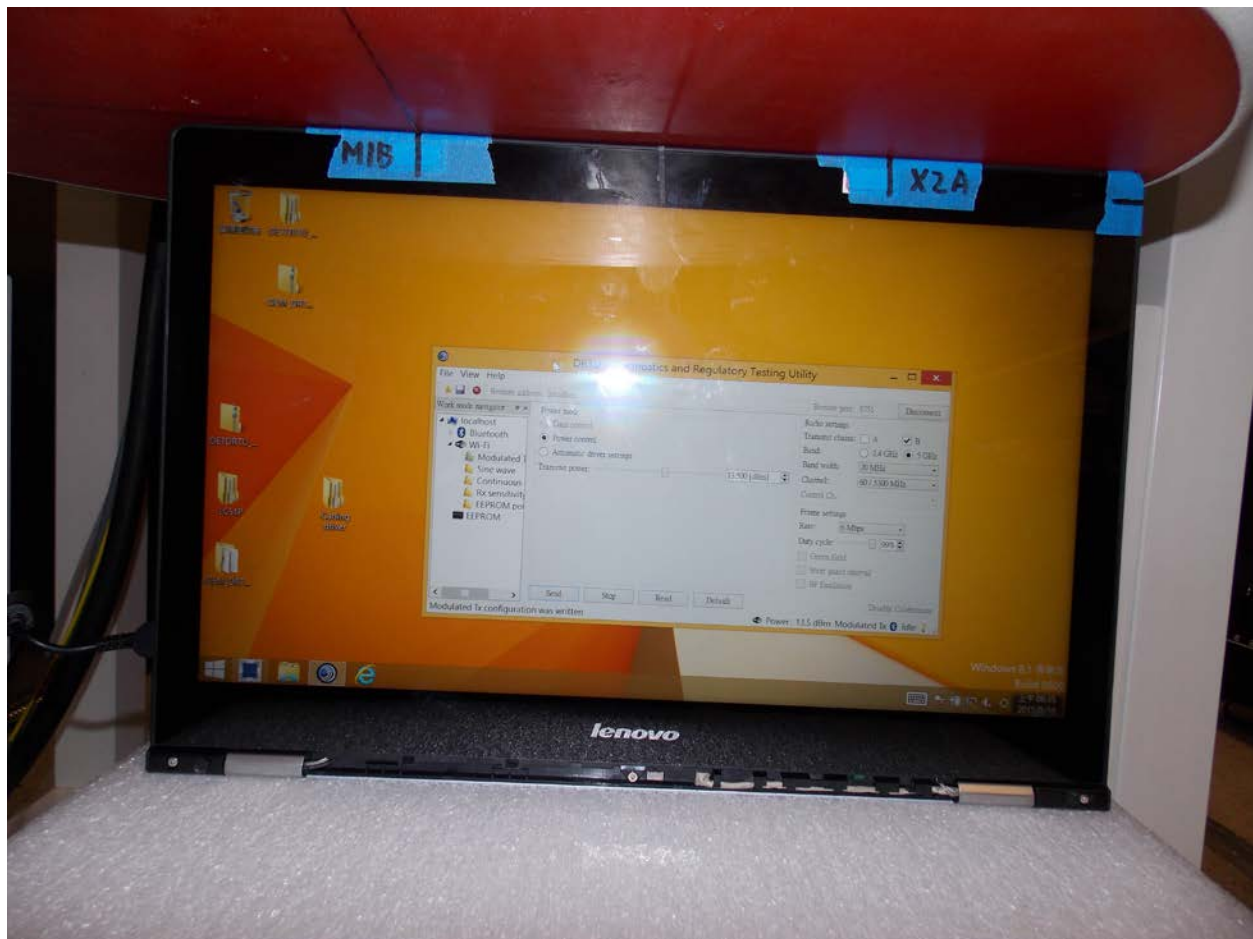
Test Position Tablet Edge 0 mm Gap
