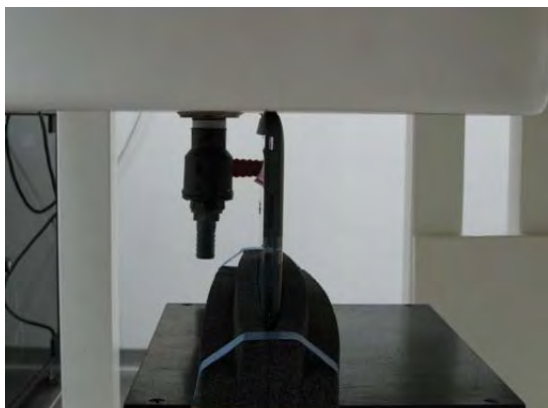
Fig.4 EUT top edge to flat phantom
