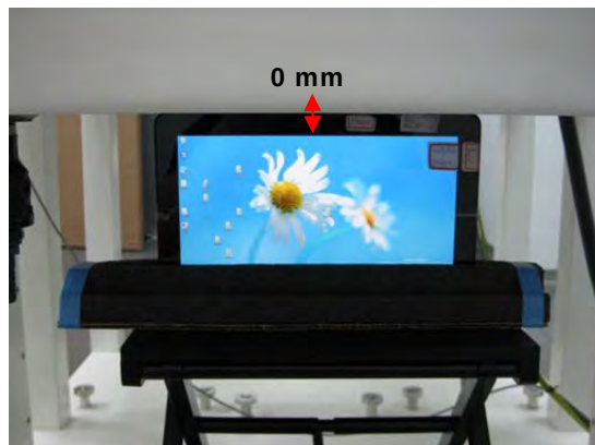
Fig.4 EUT top edge to flat phantom
