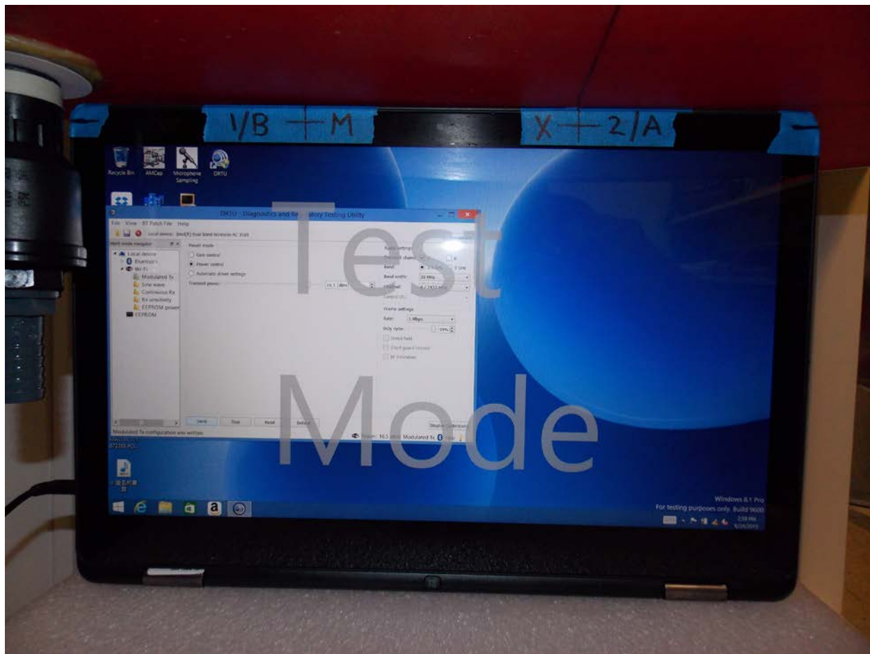
Test Position Tablet Mode Top Edge 0 mm Gap
