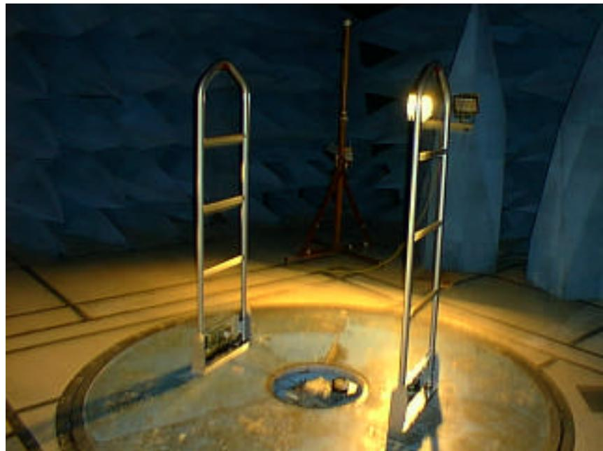
**PHOTOGRAPHS 2 & 3: RADIATED EMISSION SETUP.**
