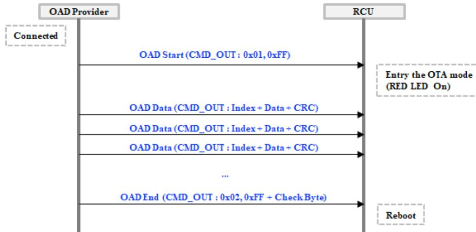
Note1 : OAD Data = Index(2byte) + Data(16byte) + CRC(2byte)
