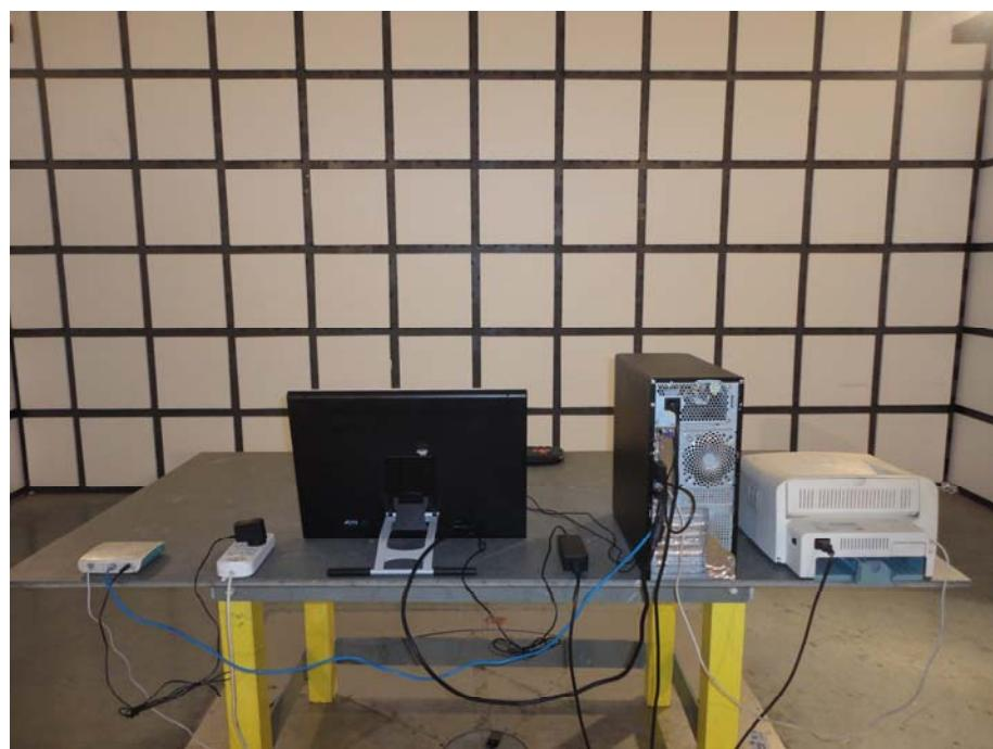
**RADIATED EMISSION TEST (PC BY HDMI)**
