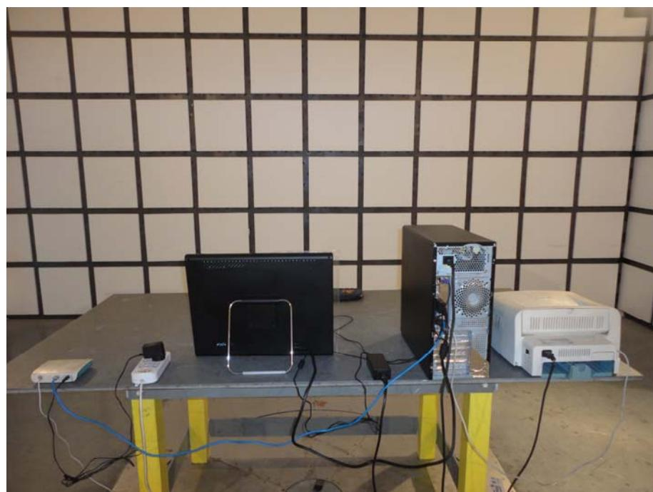
**RADIATED EMISSION TEST (PC BY HDMI)**
