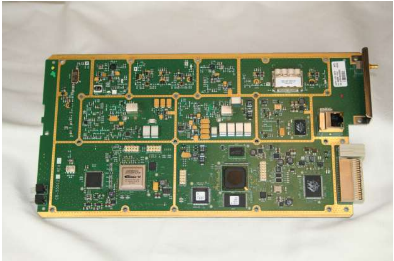
Photograph 8. TX Module (494-520MHz) Top
