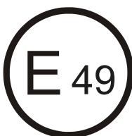
L'unità ricevitore MVRCAN (modello RNF) è conforme al regolamento ECE R10-05 con il numero di omologazione E49 10R-050048.
