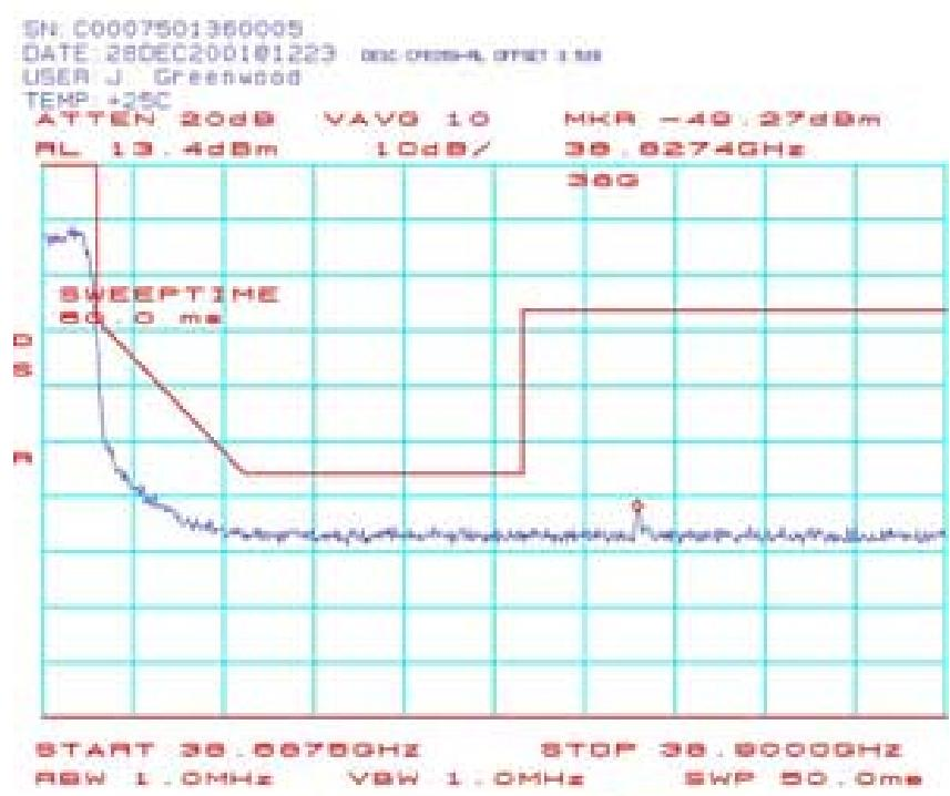
**CPE061: Spectrum Mask Plots (CPE-ODU) 38.6875 GHz 64-QAM:**
