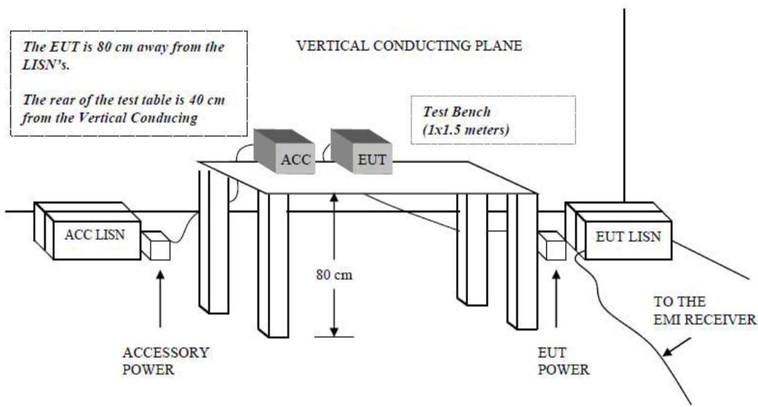
***FIGURE 2: LAYOUT OF THE SEMI-ANECHOIC TEST CHAMBER***
