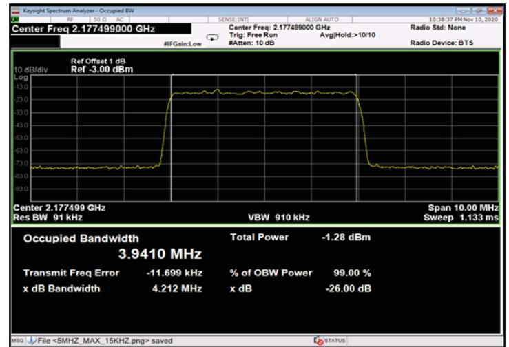
Figure 410: 256QAM 5MHz C.S.; 2177.5MHz, 30kHz - Input
