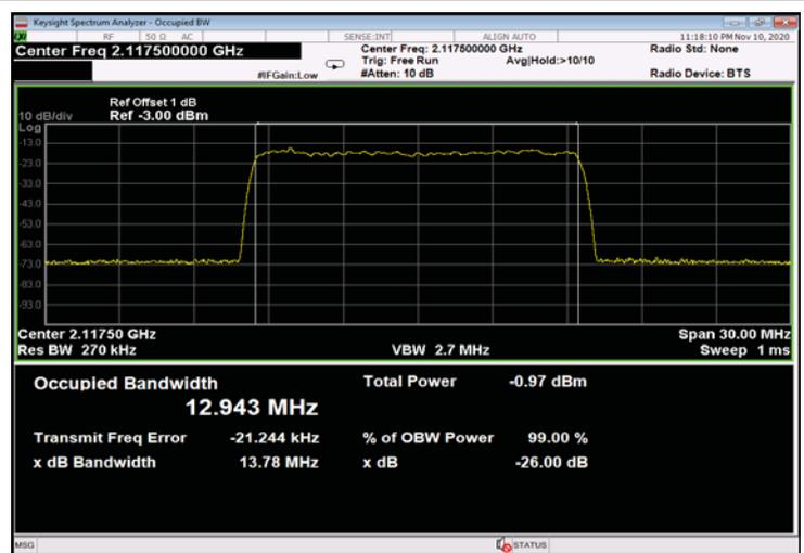
Figure 422: 256QAM 10MHz B.W.; 2117.5MHz, 60kHz - Input
