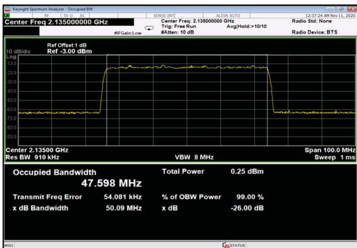
Figure 457: 256QAM 50MHz B.W.; 2135.0MHz, 30kHz - Input
