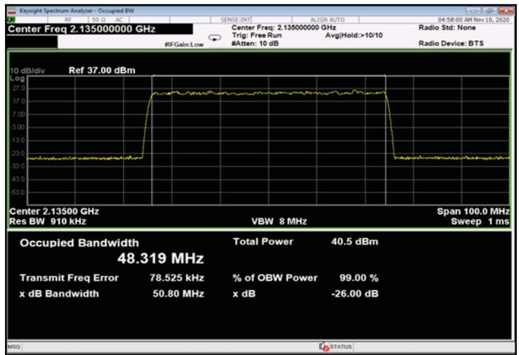
Figure 390: 64QAM 50MHz B.W.; 2135.0MHz, 15kHz - Input
