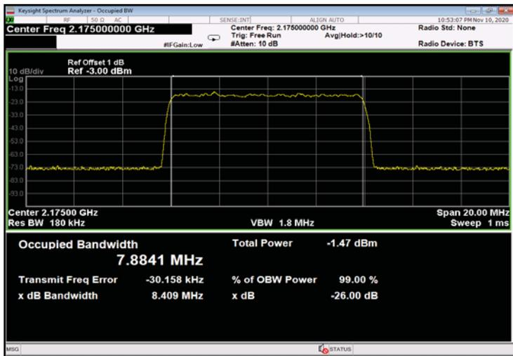
Figure 419: 256QAM 10MHz B.W.; 2175.0MHz, 60kHz - Input
