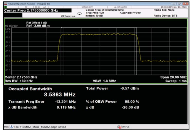
Figure 418: 256QAM 10MHz B.W.; 2175.0MHz, 30kHz - Input
