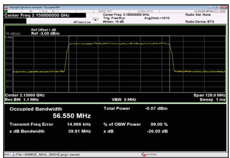
Figure 470: 256QAM 60MHz B.W.; 2150.0MHz, 60kHz - Input
