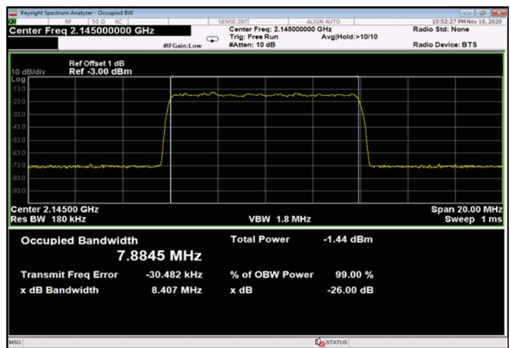
Figure 416: 256QAM 10MHz B.W.; 2145.0MHz, 60kHz - Input
