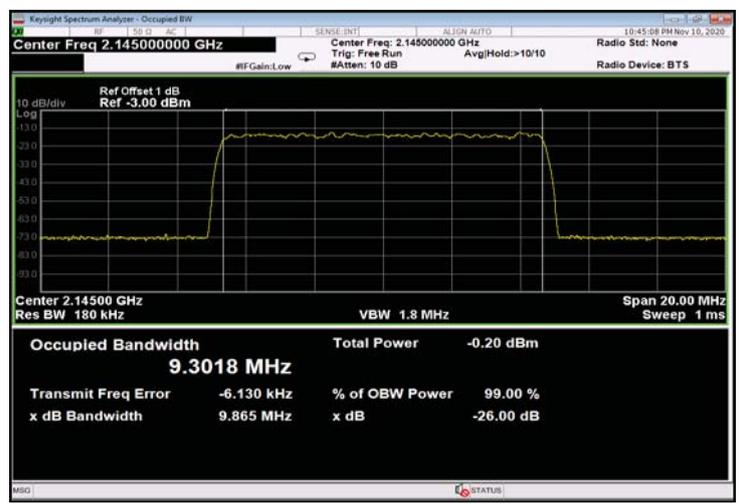
Figure 414: 256QAM 10MHz B.W.; 2145.0MHz, 15kHz - Input
