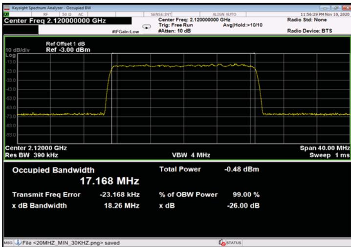
Figure 431: 256QAM 20MHz B.W.; 2120.0MHz, 60kHz - Input
