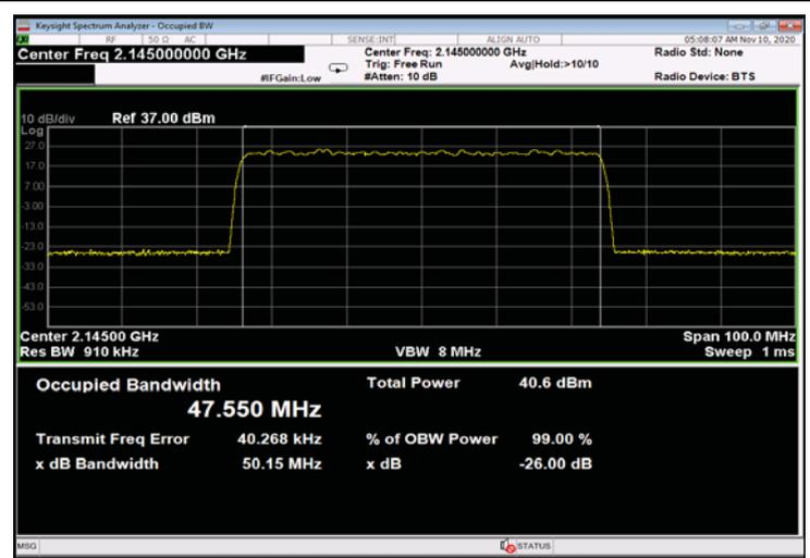
Figure 394: 64QAM 50MHz B.W.; 2145.0MHz, 30kHz - Input
