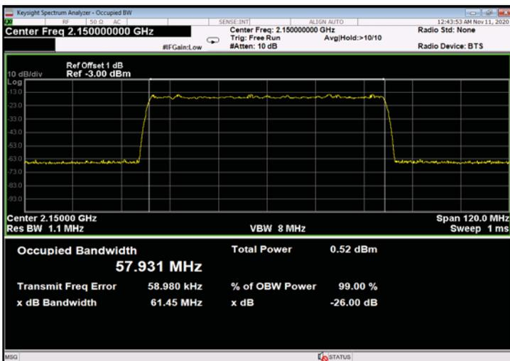
Figure 469: 256QAM 60MHz B.W.; 2150.0MHz, 30kHz - Input
