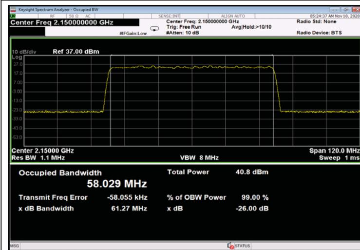
Figure 403: 64QAM 60MHz B.W.; 2150.0MHz, 30kHz - Input
