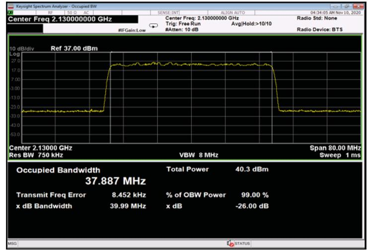
Figure 382: 64QAM 40MHz B.W.; 2130.0MHz, 30kHz - Input
