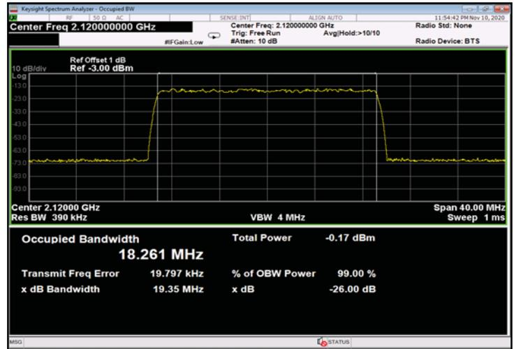
Figure 430: 256QAM 20MHz B.W.; 2120.0MHz, 30kHz - Input
