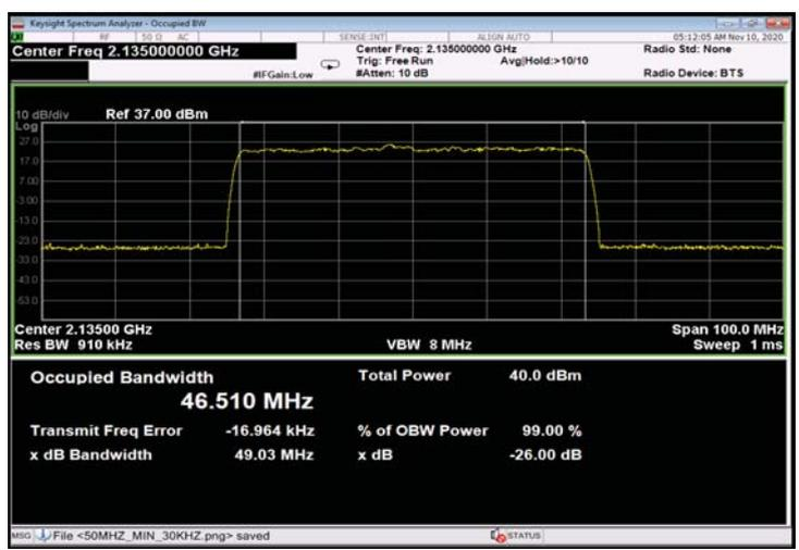
Figure 392: 64QAM 50MHz B.W.; 2135.0MHz, 60kHz - Input
