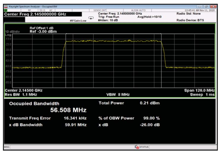
Figure 468: 256QAM 60MHz B.W.; 2145MHz, 60kHz - Input
