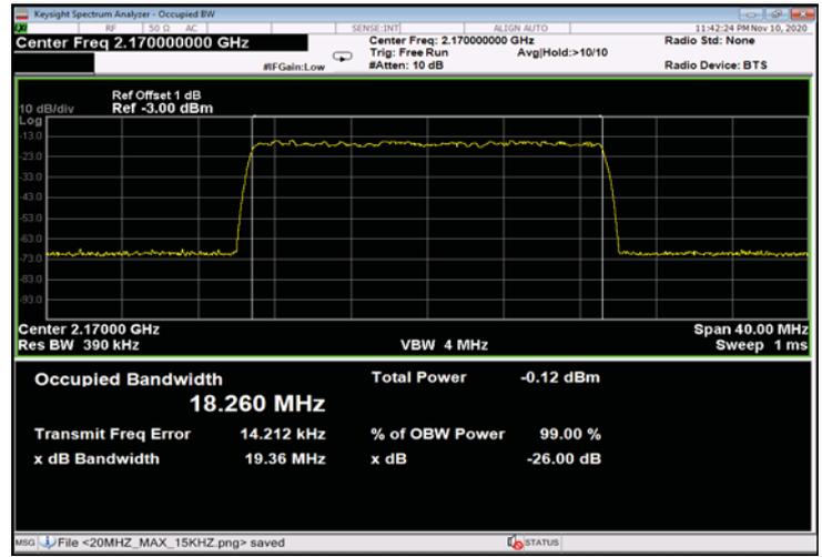
Figure 436: 256QAM 20MHz B.W.; 2170.0MHz, 30kHz - Input
