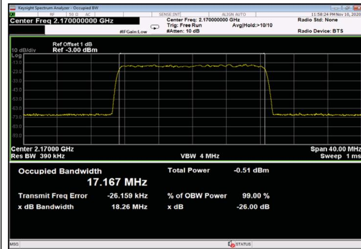
Figure 437: 256QAM 20MHz B.W.; 2170.0MHz, 60kHz - Input
