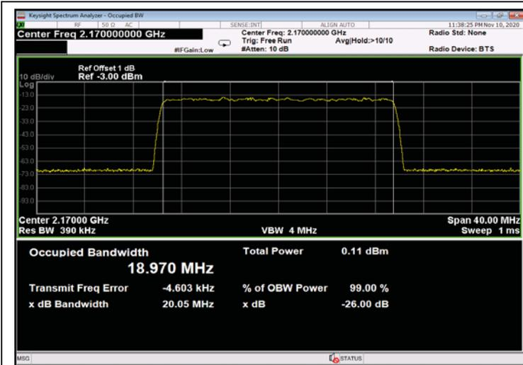
Figure 435: 256QAM 20MHz B.W.; 2170.0MHz, 15kHz - Input
