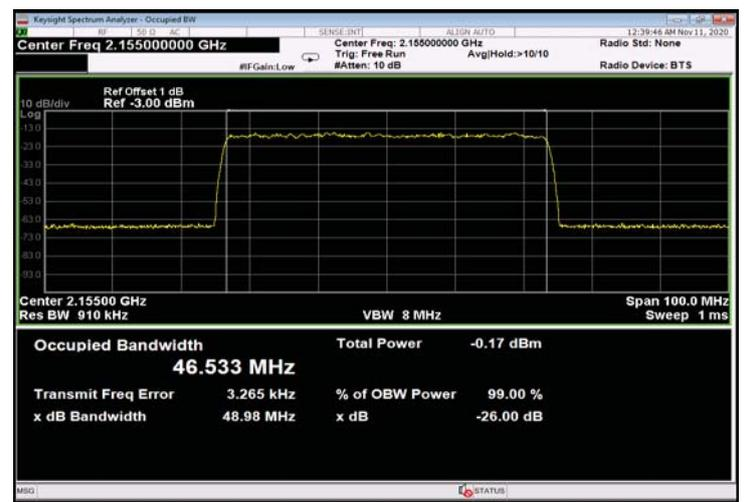
Figure 464: 256QAM 50MHz B.W.; 2155.0MHz, 60kHz - Input
