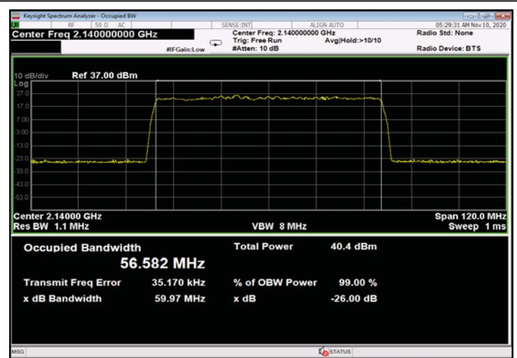
Figure 400: 64QAM 60MHz B.W.; 2140.0MHz, 60kHz - Input
