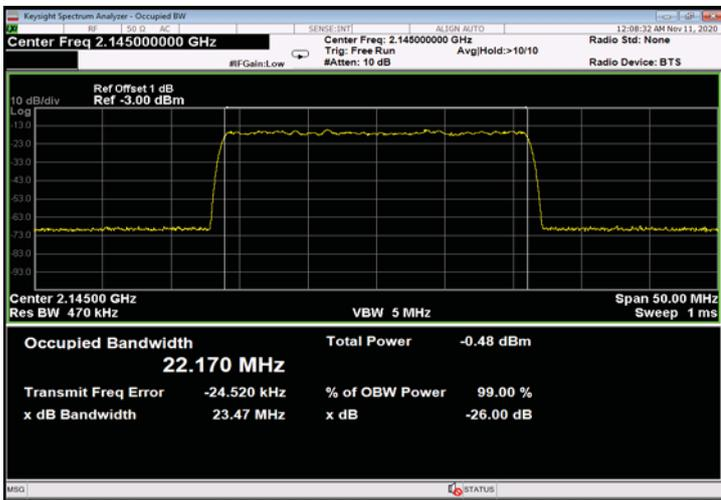
Figure 443: 256QAM 25MHz B.W.; 2145.0MHz, 60kHz - Input
