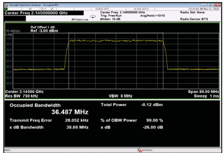
Figure 452: 256QAM 40MHz B.W.; 2145.0MHz, 60kHz - Input
