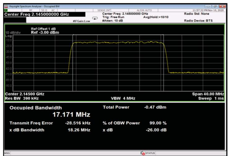
Figure 434: 256QAM 20MHz B.W.; 2145.0MHz, 60kHz - Input
