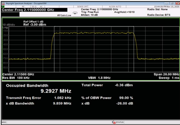
Figure 411: 256QAM 10MHz B.W.; 2115.00MHz, 15kHz - Input
