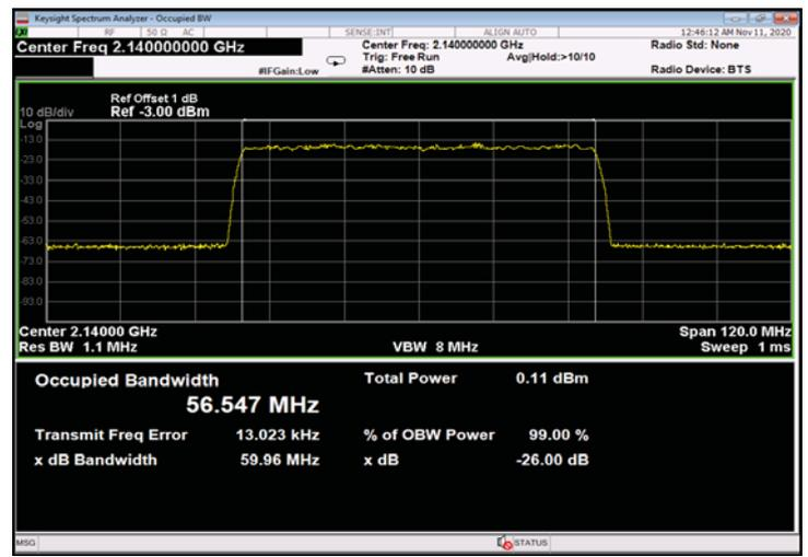
Figure 466: 256QAM 60MHz B.W.; 2140.0MHz, 60kHz - Input
