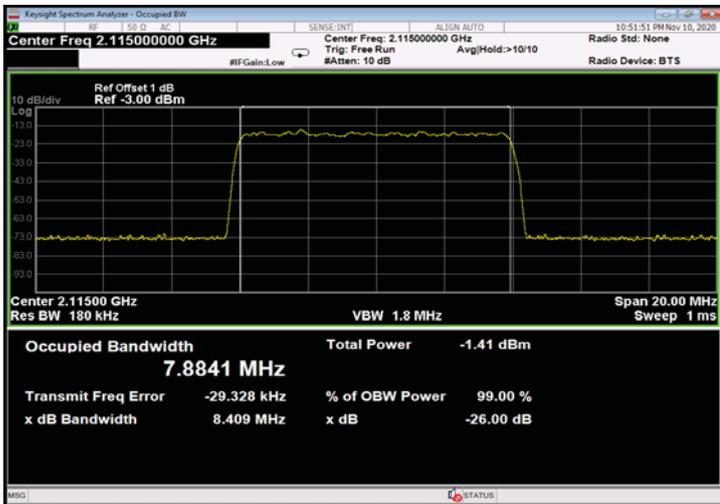
Figure 413: 256QAM 10MHz B.W.; 2115.0MHz, 60kHz - Input
