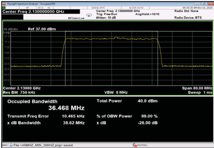
Figure 383: 64QAM 40MHz B.W.; 2130.0MHz, 60kHz - Input
