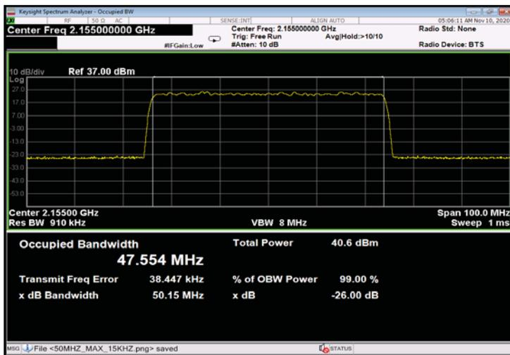
Figure 397: 64QAM 50MHz B.W.; 2155.0MHz, 30kHz - Input
