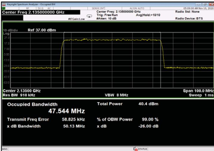
Figure 391: 64QAM 50MHz B.W.; 2135.0MHz, 30kHz - Input
