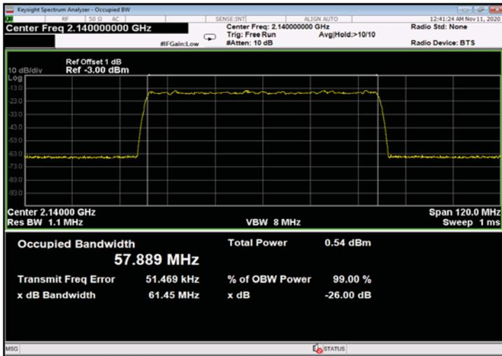
Figure 465: 256QAM 60MHz B.W.; 2140.0MHz, 30kHz - Input
