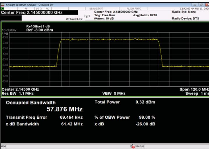
Figure 467: 256QAM 60MHz B.W.; 2145.0MHz, 30kHz - Input
