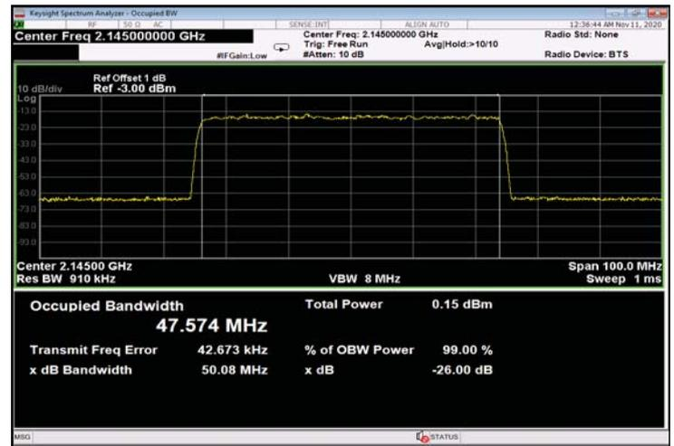
Figure 460: 256QAM 50MHz B.W.; 2145.0MHz, 30kHz - Input
