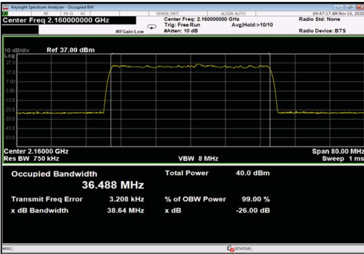
Figure 389: 64QAM 40MHz B.W.; 2160.0MHz, 60kHz - Input
