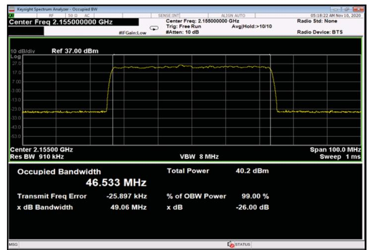
Figure 398: 64QAM 50MHz B.W.; 2155.0MHz, 60kHz - Input
