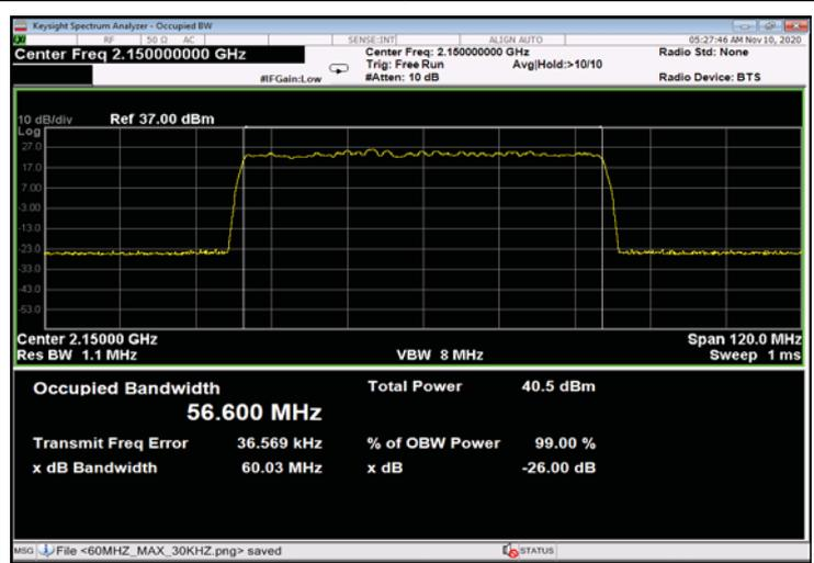
Figure 404: 64QAM 60MHz B.W.; 2150.0MHz, 60kHz - Input
