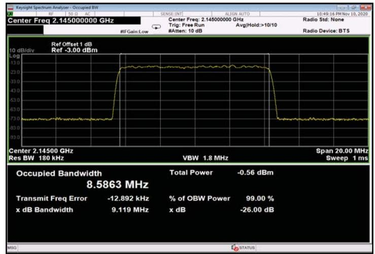
Figure 412: 256QAM 10MHz B.W.; 2115.0MHz, 30kHz - Input
