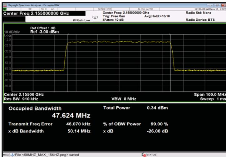
Figure 463: 256QAM 50MHz B.W.; 2155.0MHz, 30kHz - Input
