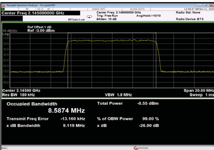
Figure 415: 256QAM 10MHz B.W.; 2145.0MHz, 30kHz - Input
