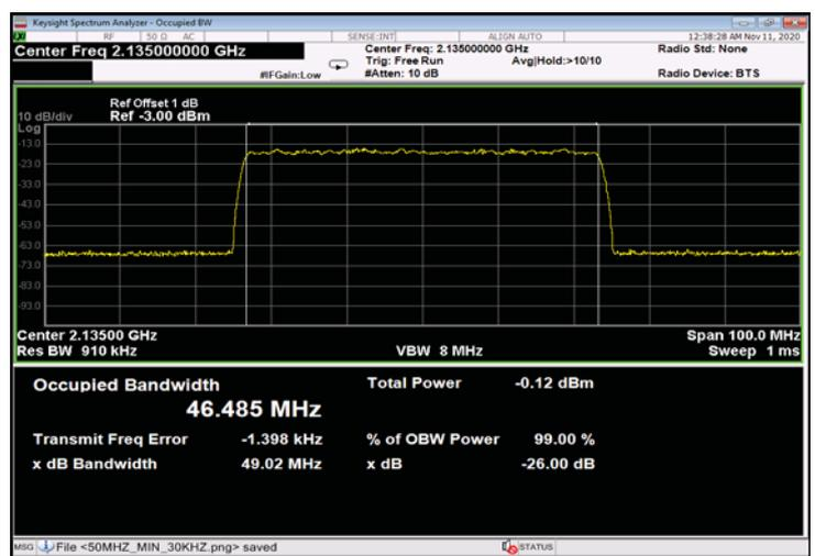
Figure 458: 64QAM 50MHz B.W.; 2135.0MHz, 60kHz - Input
