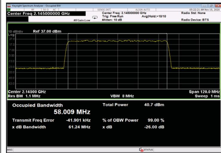
Figure 401: 64QAM 60MHz B.W.; 2145.0MHz, 30kHz - Input
