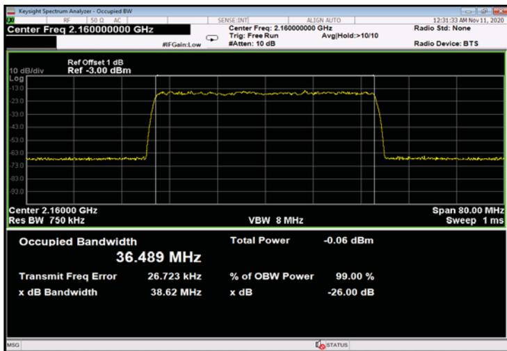
Figure 455: 256QAM 40MHz B.W.; 2160.0MHz, 60kHz - Input
