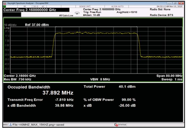
Figure 388: 64QAM 40MHz B.W.; 2160.0MHz, 30kHz - Input
