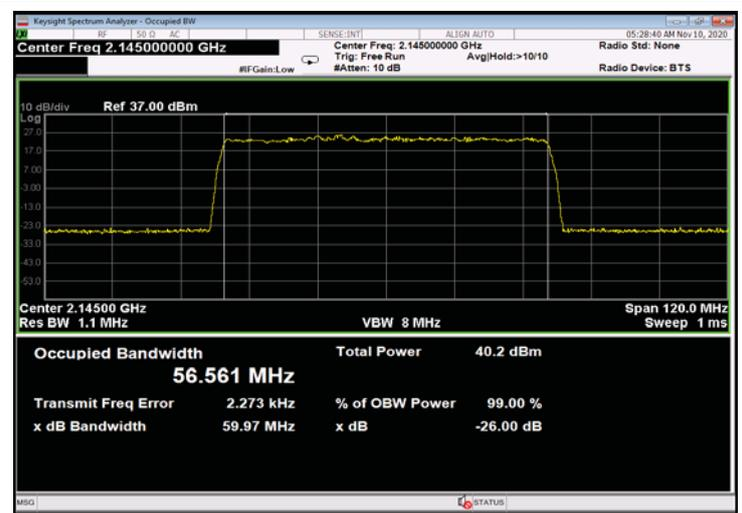
Figure 402: 64QAM 60MHz B.W.; 2145.0MHz, 60kHz - Input
