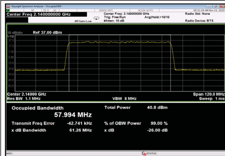
Figure 399: 64QAM 60MHz B.W.; 2140.0MHz, 30kHz - Input
