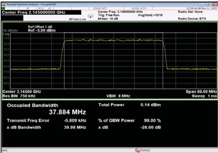
Figure 451: 256QAM 40MHz B.W.; 2145.0MHz, 30kHz - Input
