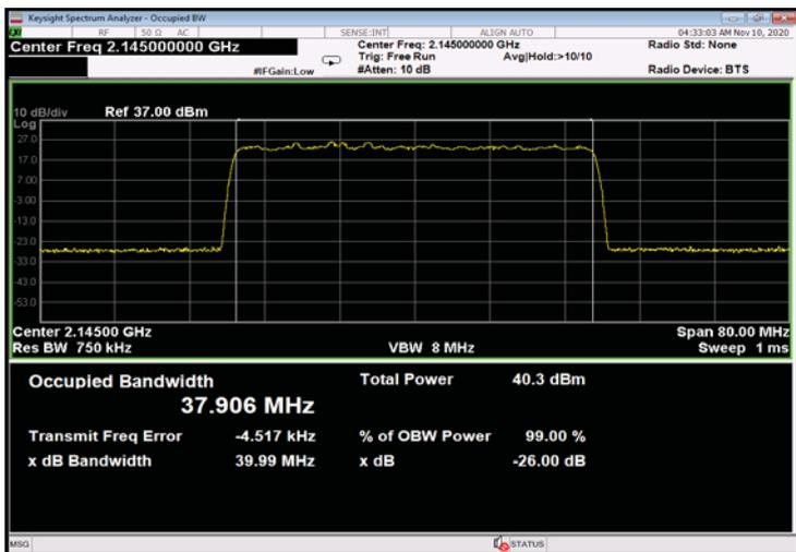
Figure 385: 64QAM 40MHz B.W.; 2145.0MHz, 30kHz - Input
