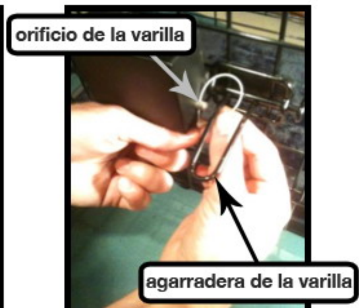
Figura 8: Levante la manija de la varilla de cierre y utilice una de las cintas de ajuste para asegurarlo en la posición requerida a través del orificio.
