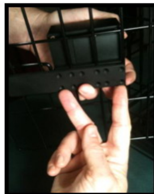
Figure 5. Sélectionnez les deux paires de trous dégagés les plus éloignés. Ceux-ci vont devenir vos trous externes.
