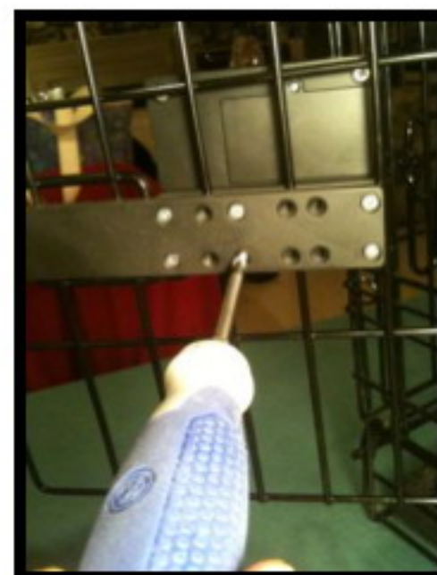
Figure 6. Installez les vis dans les quatre trous externes + 2 autres trous souples.
