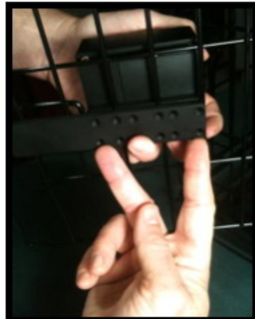
Figura 5: Seleccione los 2 orificios más lejos que no estén obstruidos. Estos serán los orificios del otro lado.
