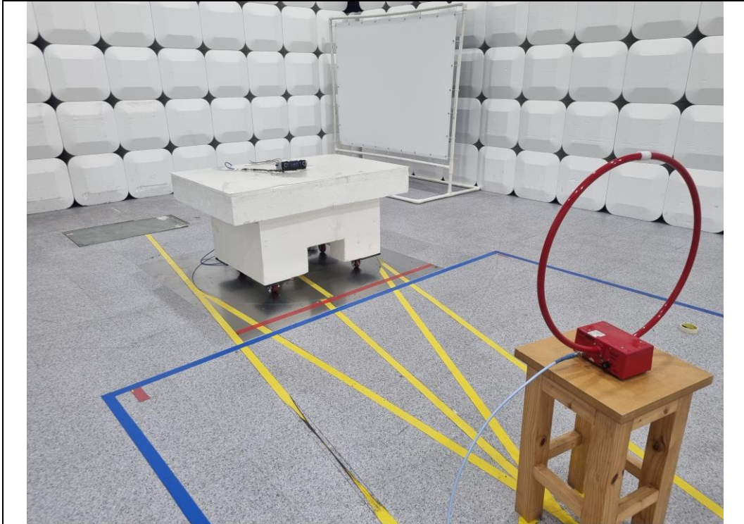
Test distance : 3 m, height of table : 0.8 m
