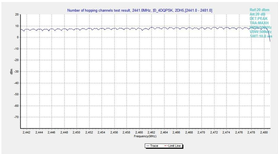
Fig.97. Number of hopping frequencies:  $\pi/4$  DQPSK, Channel 40 - 78
