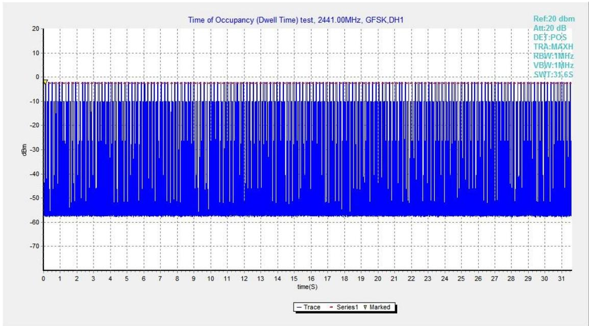
Fig.65. Number of Transmissions Measurement: Channel 39,Packet DH1
