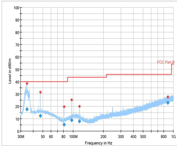
Fig.45 Radiated emission:  $\pi/4$  DQPSK, Ch0, 30MHz~1GHz
