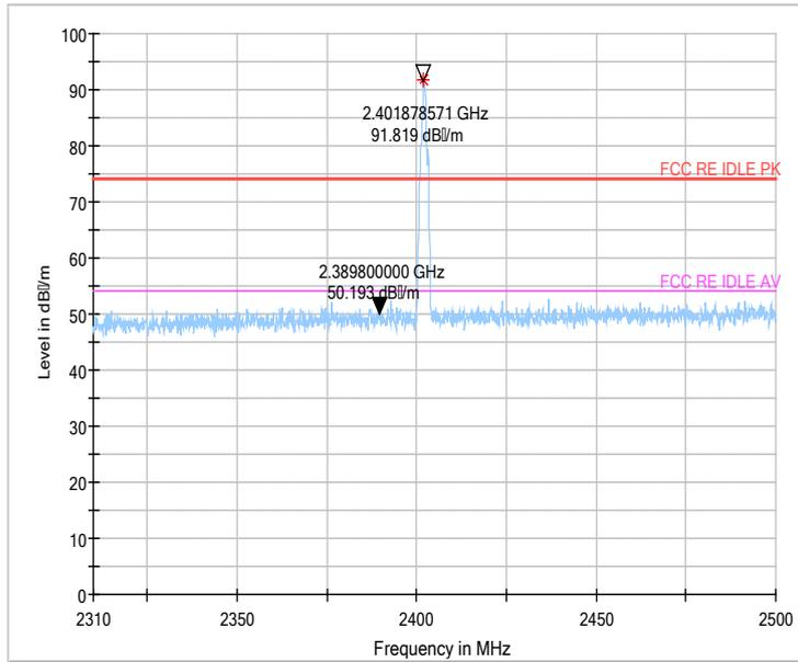
Fig.48 Radiated emission (Power):  $\pi/4$  DQPSK, low channel
