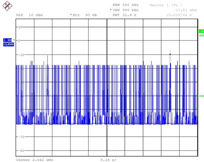
Fig.56 Number of Transmissions Measurement: Ch39, Packet DH1
