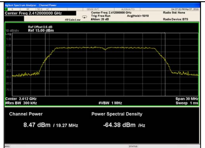
802.11g - AV Output power - Low CH 2412
