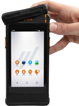
Figure 84 : retrait du capuchon de protection logistique supérieur
