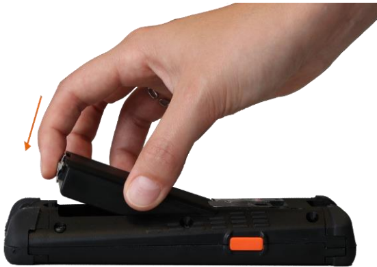
Figura 58: Inserción de la batería recargable
