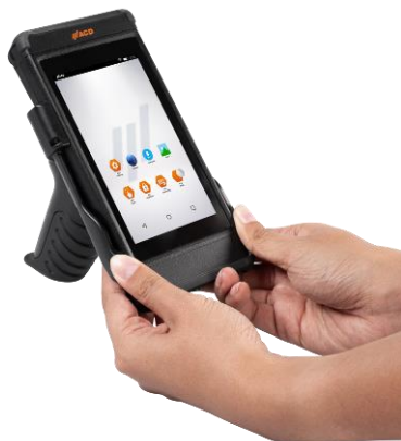
Figure 79 : retrait de la M2Grip5 du M2Smart®SE (1/2 )
