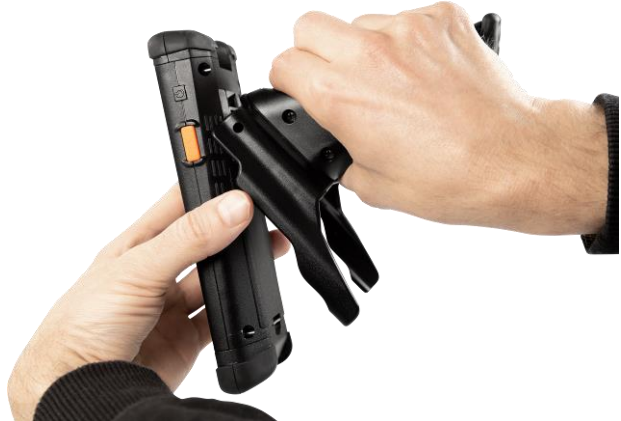
Figure 80 : retrait de la M2Grip5 du M2Smart®SE (2/2)
