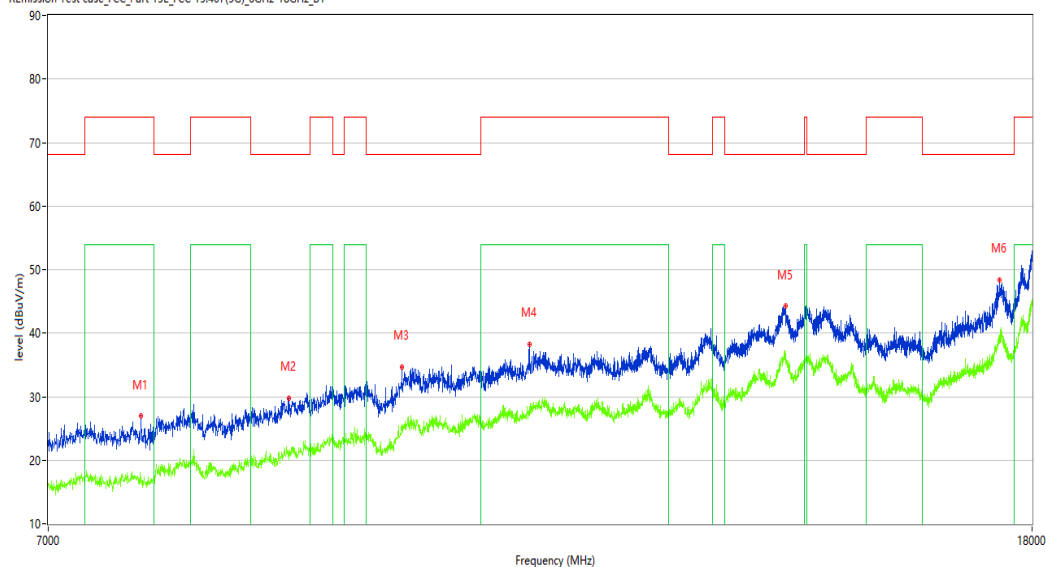
REmission Test case_FCC_Part 15E_FCC 15.407(5G)_6GHz-18GHz_B1
