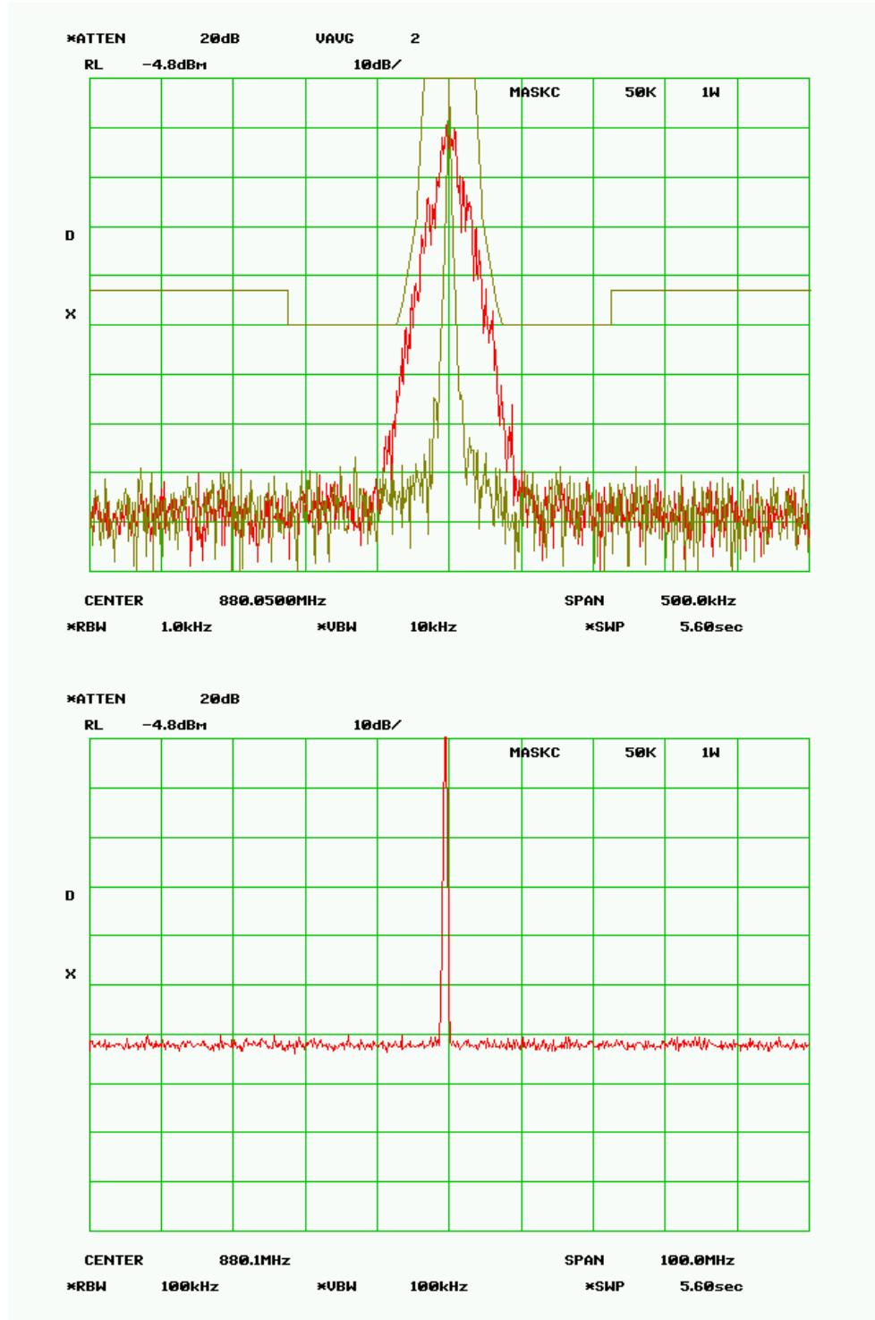
**MASK C - 10 Watts****RF Frequency 880.050 MHz****SPECTRUM FOR EMISSION - 29K5F1D**
