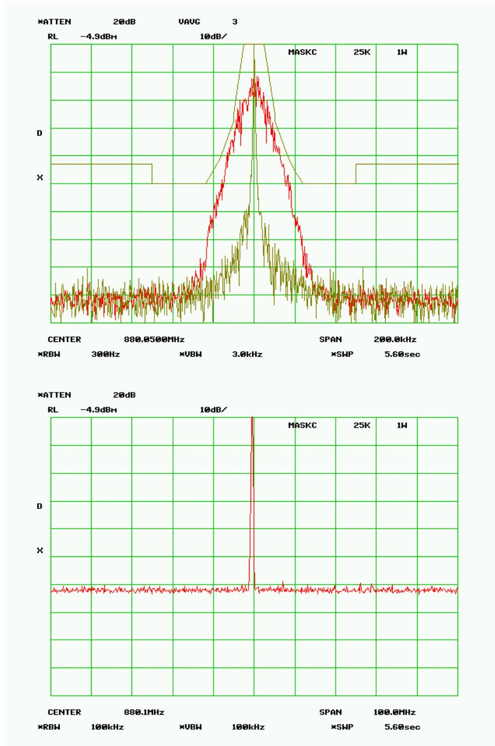
**MASK C - 10 Watts****RF Frequency 880.050 MHz****SPECTRUM FOR EMISSION - 17K0F1D**
