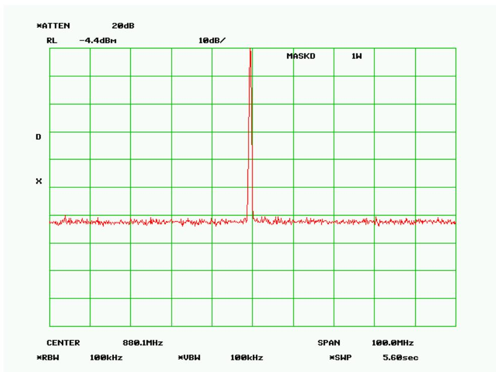
**MASK D - 10 Watts****RF Frequency 880.050 MHz****SPECTRUM FOR EMISSION - 8K08F1D**
