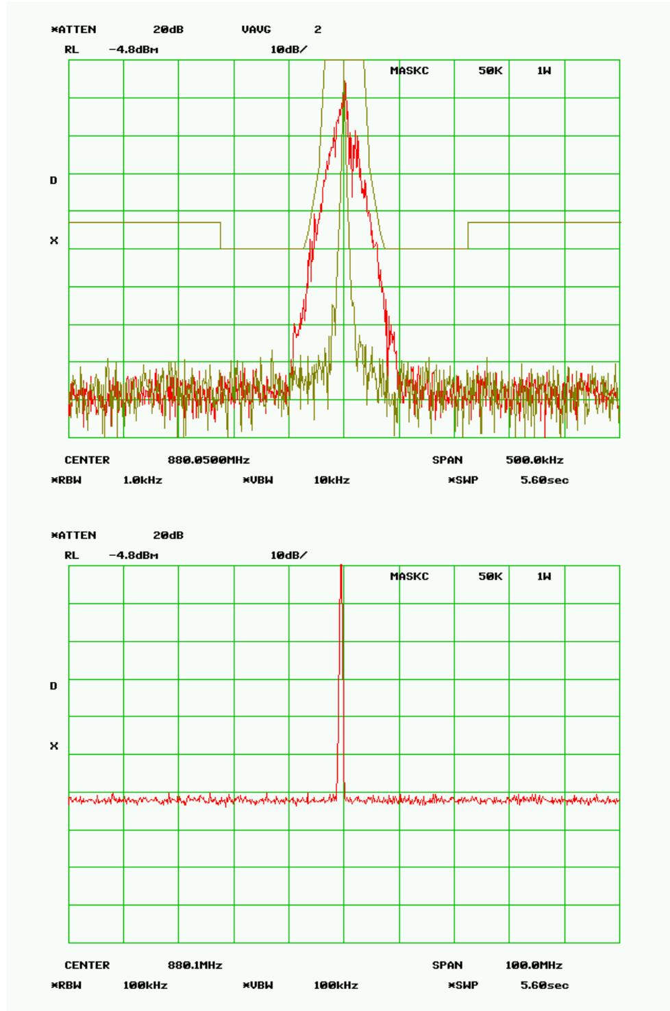
**MASK C - 10 Watts****RF Frequency 880.050 MHz****SPECTRUM FOR EMISSION - 30K5F1D**
