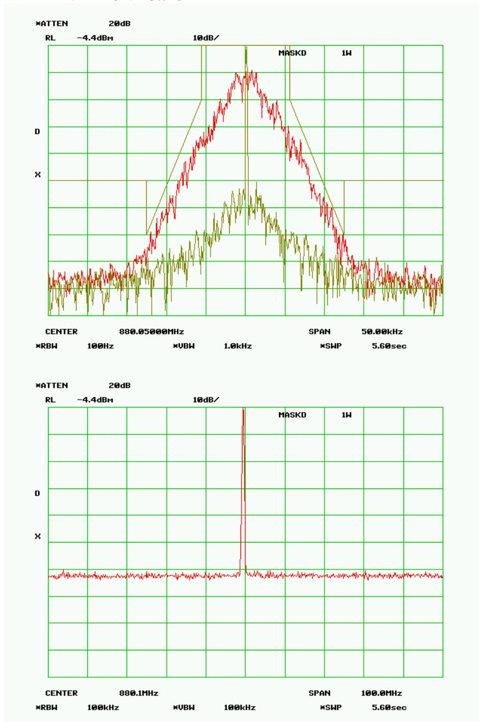
**MASK D - 10 Watts****RF Frequency 880.050 MHz****SPECTRUM FOR EMISSION - 8K50F1D**
