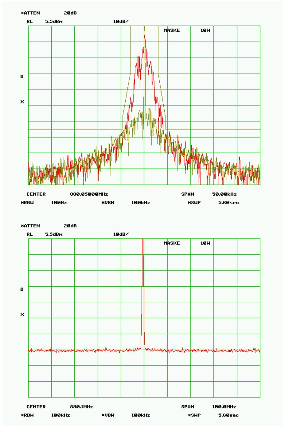
**MASK E – 1.0 Watts****RF Frequency 880.050 MHz****SPECTRUM FOR EMISSION - 3K55F1D**
