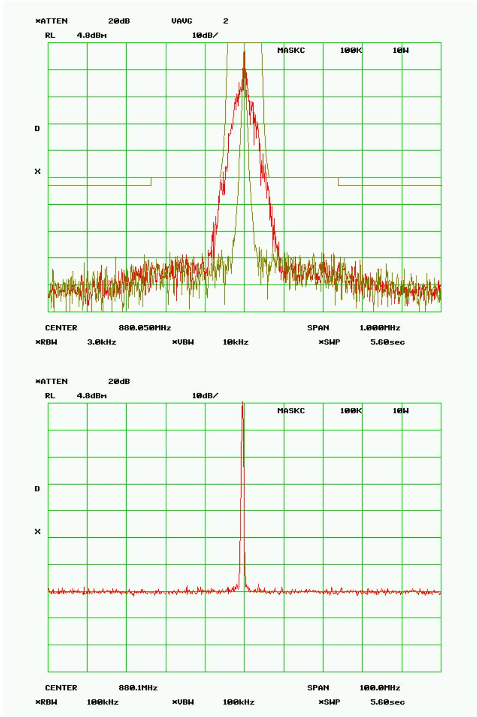
**MASK C – 1.0 Watt****RF Frequency 880.050 MHz****SPECTRUM FOR EMISSION - 49K7F1D**
