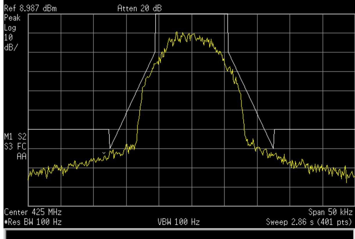
Frequency: 469.000 MHz. F1D 12.5 kHz, 8 kbps
