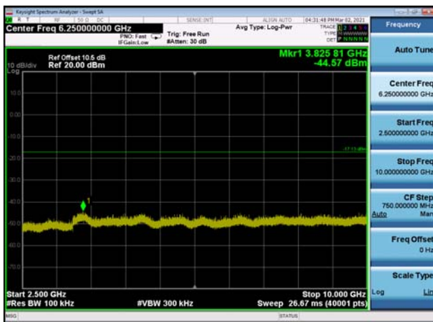
,Plot 4,2500MHz~10000MHz-802.11g ,2462MHz
