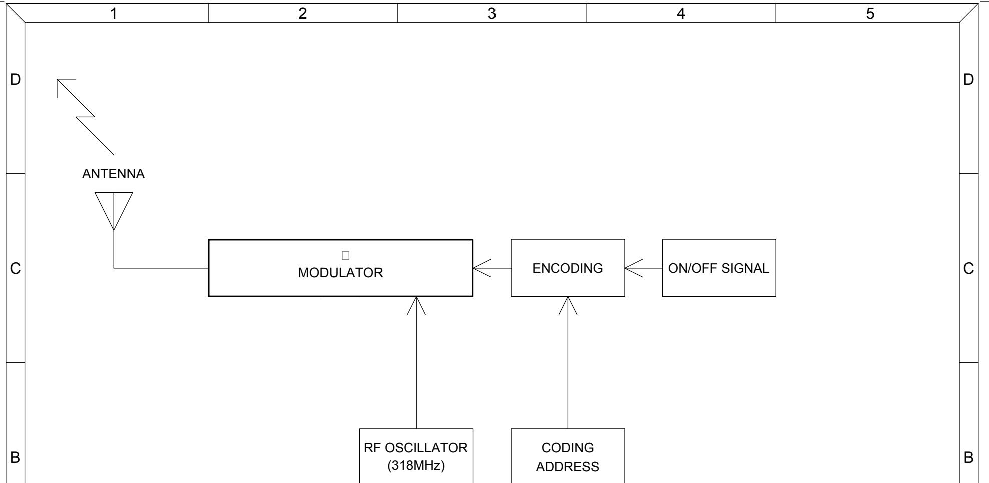
REMOTE CONTROL TRANSMITTER SYSTEM BLOCK DIAGRAM
