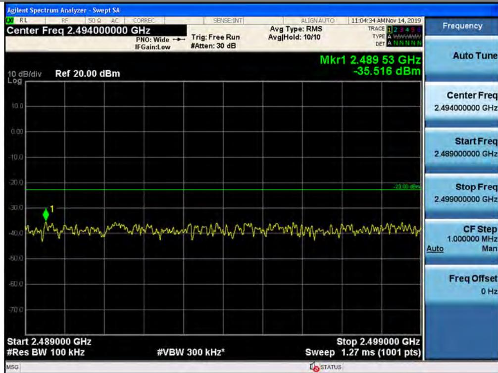
Spurious / BRS/EBS / Downlink / LTE 20 MHz / Middle / High Edge + 1 MHz ~ High Edge + 11 MHz
