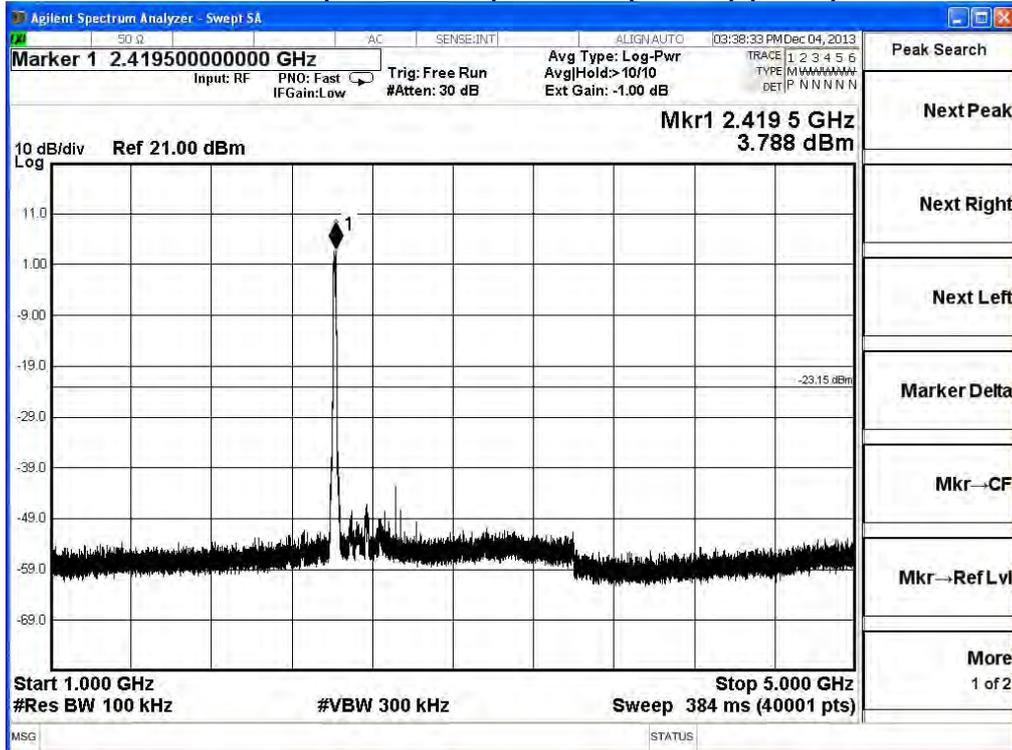
2412MHz (5GHz-9GHz)-802.11n(20MHz) (Ant 0)
