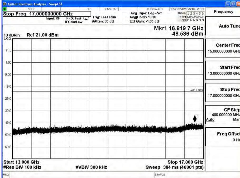
2412MHz (17GHz-21GHz) -802.11n(20MHz) (Ant 0)
