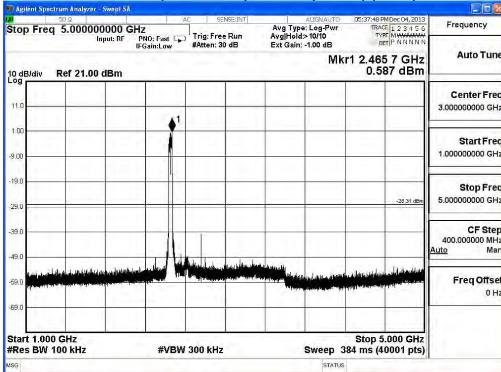
2452MHz (5GHz-9GHz)-802.11n(40MHz) (Ant 0)
