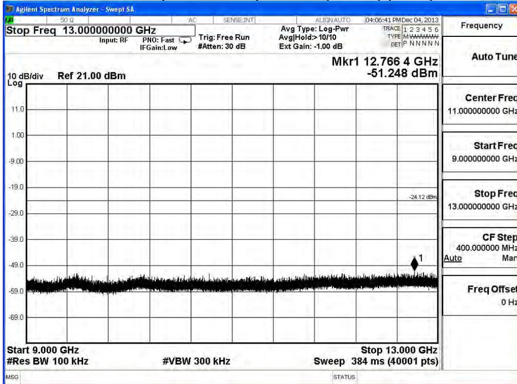
2462MHz (13GHz-17GHz)-802.11n(20MHz) (Ant 0)
