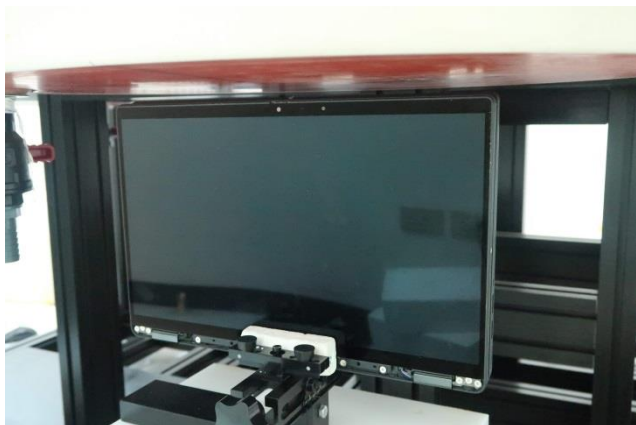
Edge 1, Test Separation 13 mm
