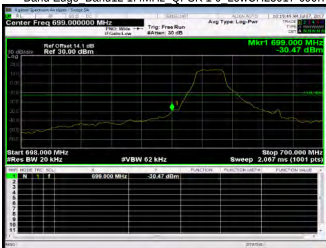
Band Edge_Band12 1.4MHz_QPSK 1 0_LowCH23017-699.7
