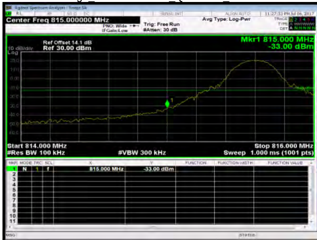
Band Edge_Band26 10MHz_QPSK 1 0_LowCH26750-820
