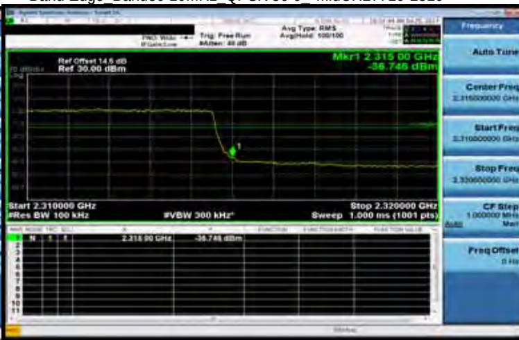
Band Edge Band30 10MHz QPSK 50 0 MidCH27710-2310
