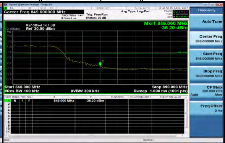
Band Edge_Band26 10MHz_QPSK 50 0_HighCH26990-844
