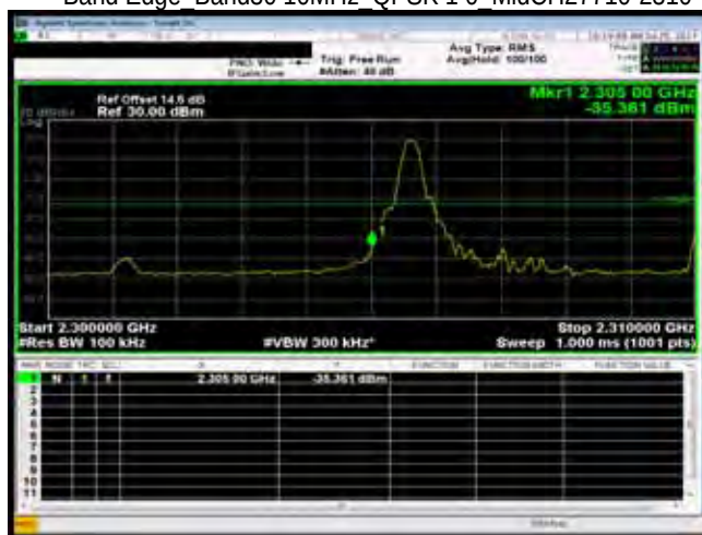
Band Edge Band30 10MHz QPSK 1 0 MidCH27710-2310
