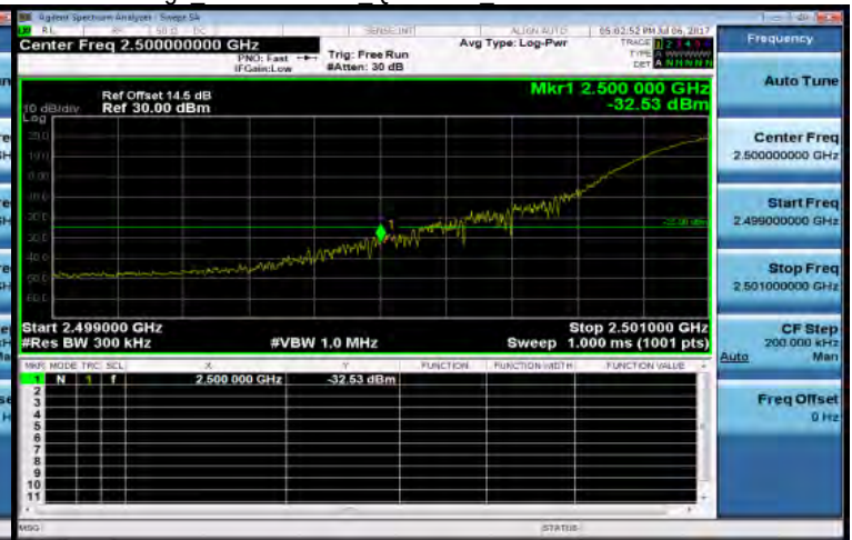
Band Edge Band7 20MHz QPSK 1 0 LowCH20850-2510
