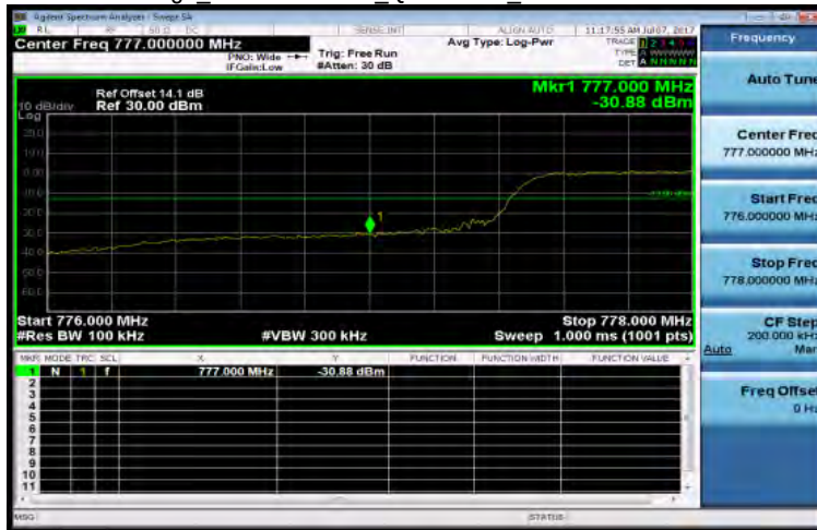
Band Edge_Band13 10MHz_QPSK 50 0_LowCH23230-782
