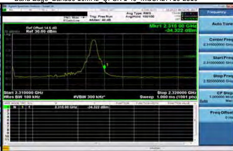
Band Edge Band30 10MHz QPSK 1 49 MidCH27710-2310
