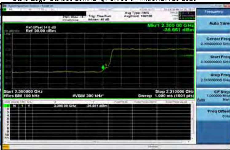
Band Edge Band30 10MHz QPSK 50 0 MidCH27710-2310
