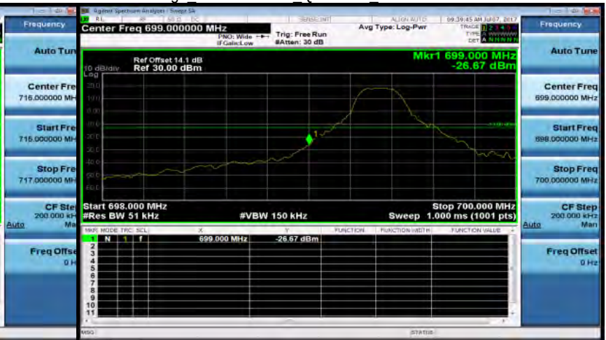
Band Edge_Band12 5MHz_QPSK 1 0_LowCH23035-701.5
