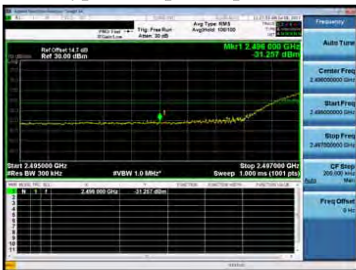
Band Edge_Band41 20MHz_QPSK 100 0_LowCH40240-2555
