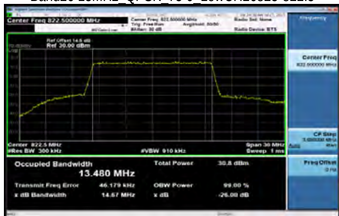
Band26 15MHz_QPSK_75 0_LowCH26825-822.5
