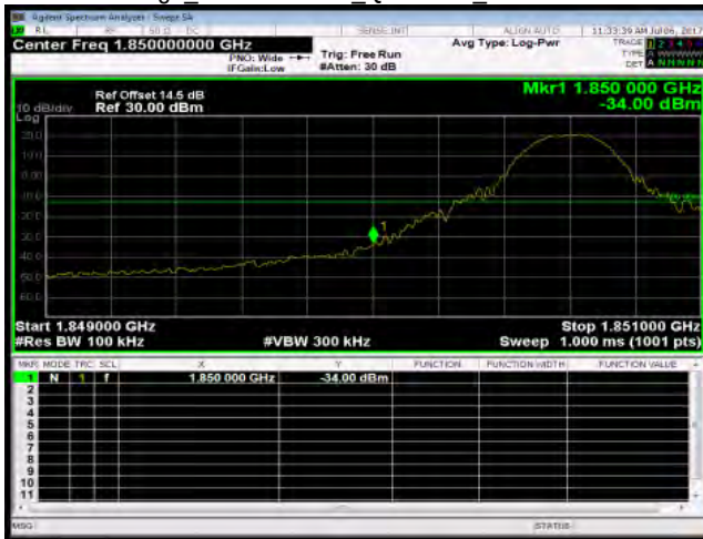
Band Edge_Band2 10MHz_QPSK 1 0_LowCH18650-1855
