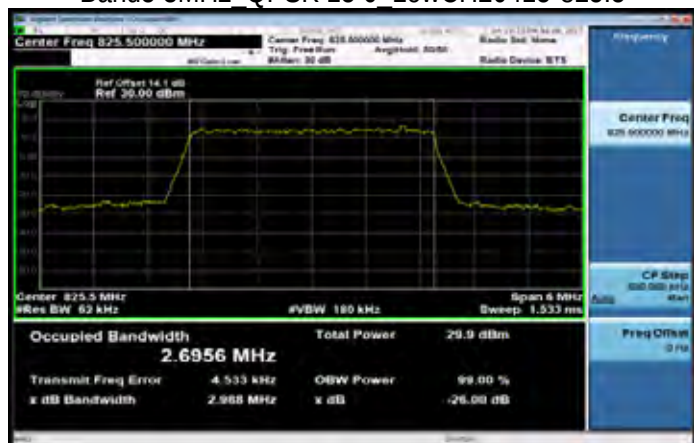
Band5 3MHz_QPSK 15 0_LowCH20415-825.5
