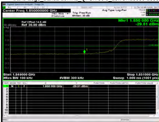
Band Edge_Band2 10MHz_QPSK 50 0_LowCH18650-1855
