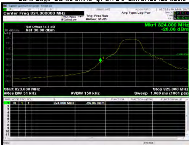
Band Edge_Band5 5MHz_QPSK 1 0_LowCH20425-826.5
