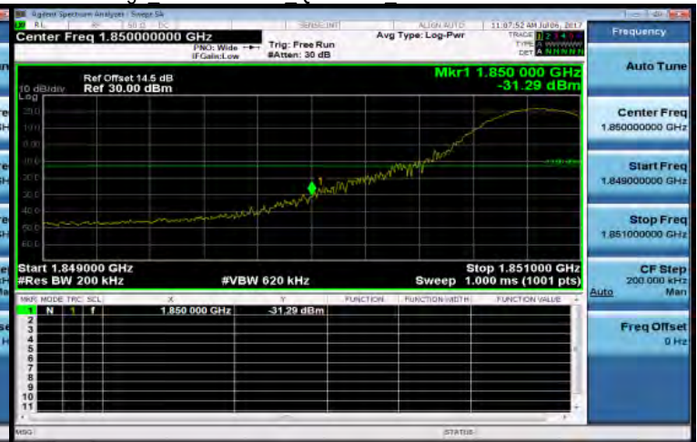
Band Edge_Band2 15MHz_QPSK 1 0_LowCH18675-1857.5
