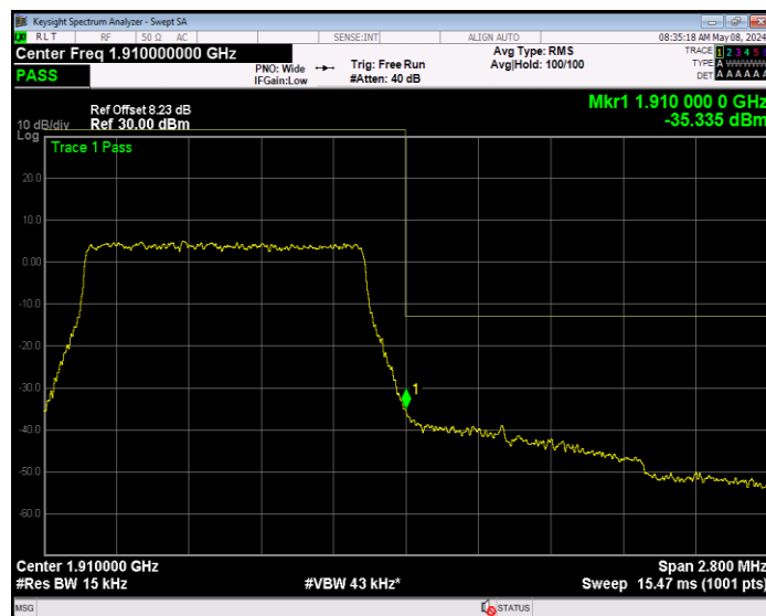
Band2 QPSK BW=10MHz Channel=18650 RB Size=1 Position=#0
