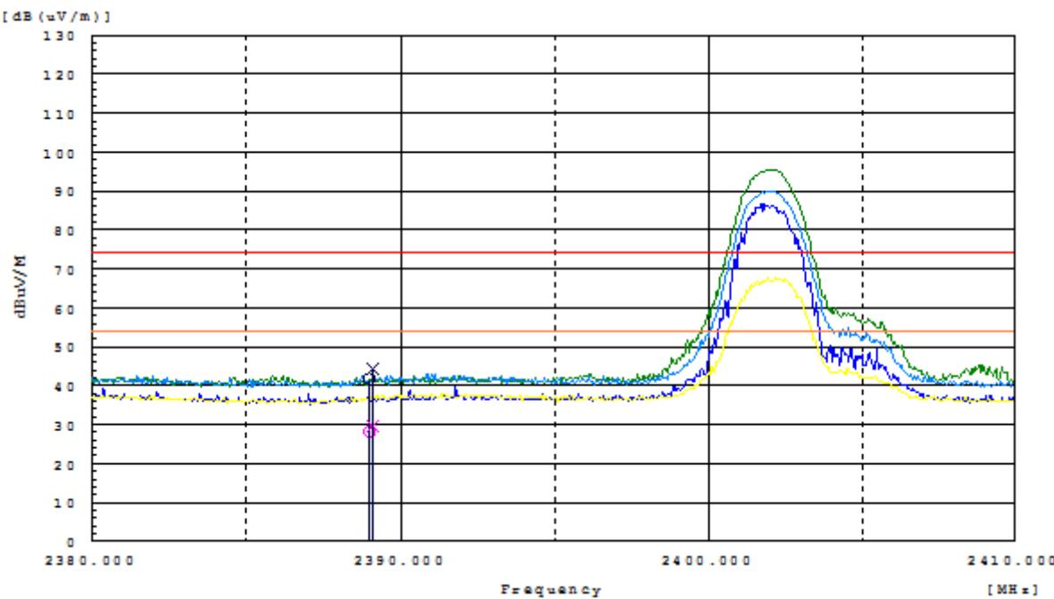
**Radiated Restricted Band Edges plot – ( $\pi/4$ DQPSK, Ch.78)**
