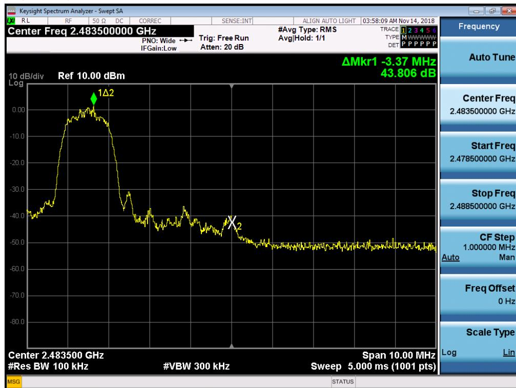
Test Plots without hopping ( $\pi/4$ DQPSK)
