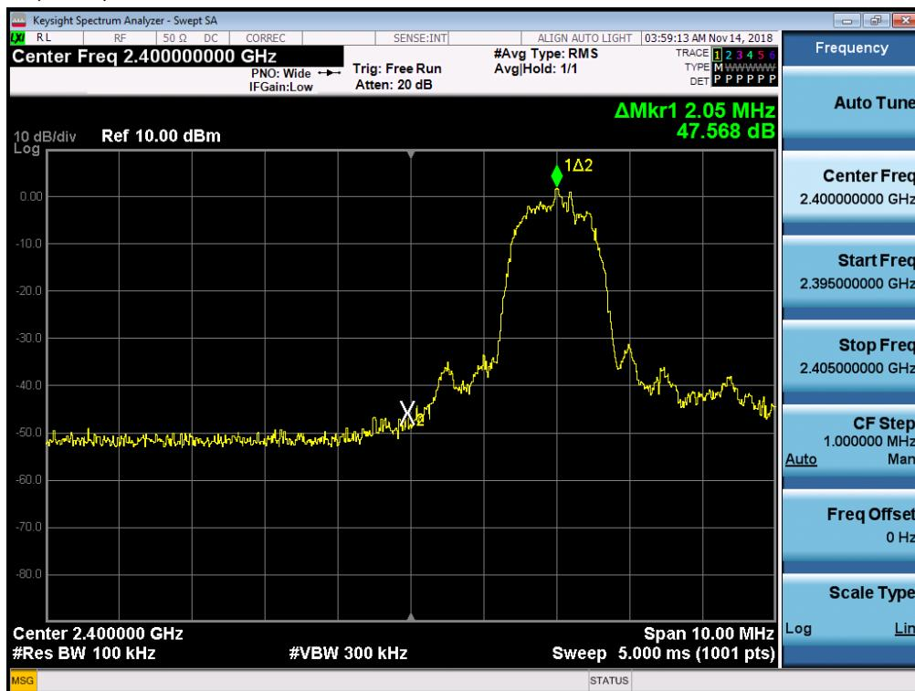
Test Plots without hopping ( $\pi/4$ DQPSK)
