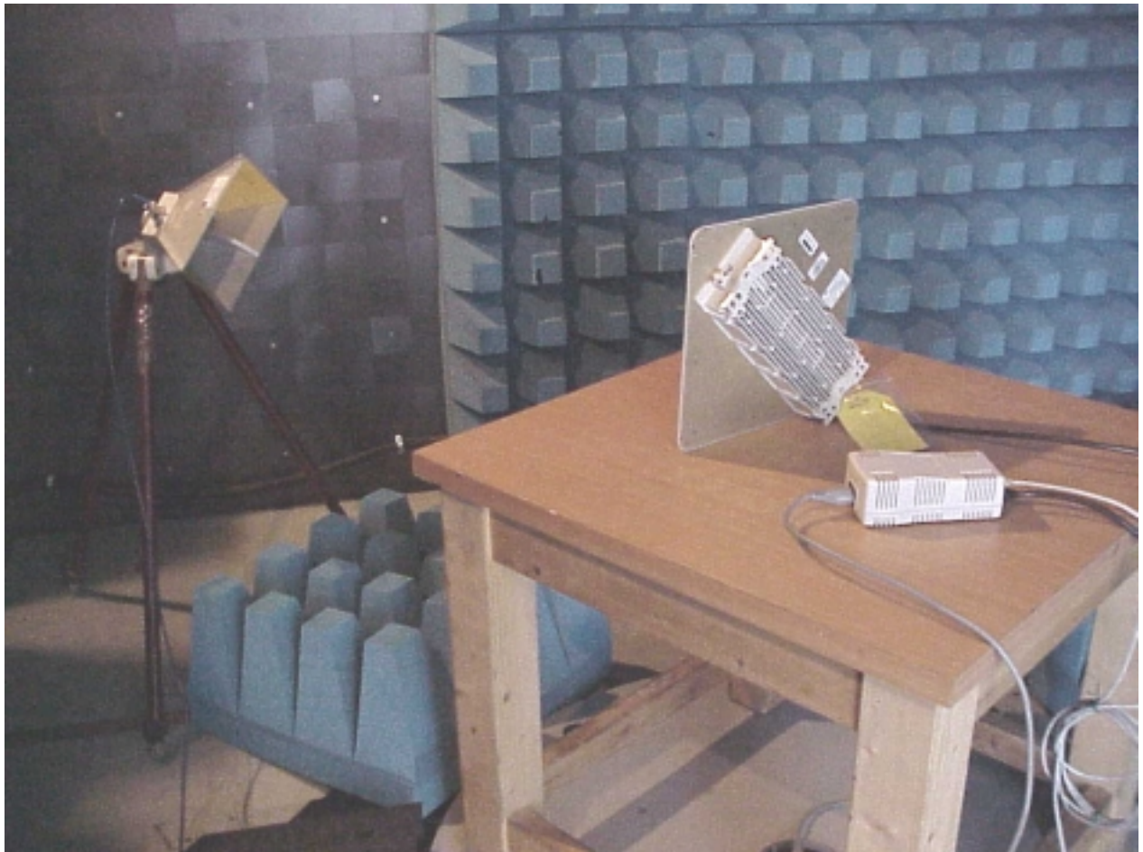
Photo #8 Spurious emission test, antenna MA-WA50-1X P/N AN1165 mfr Mars Antennas
