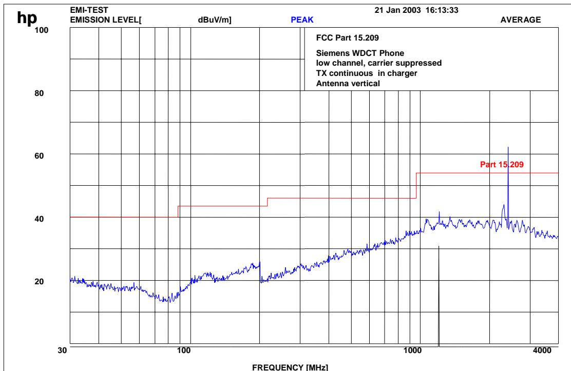
$f < 1 \text{ GHz}$  : RBW/VBW: 100 kHz $f \geq 1 \text{ GHz}$  : RBW/VBW: 1 MHz
