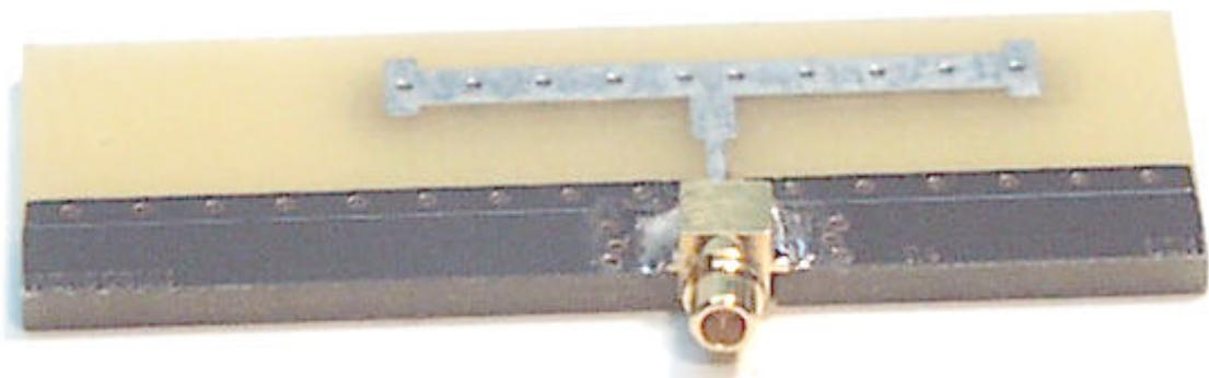
**Centurion WCP-2400-MMCX 1/4 Wave Dipole Antenna**
