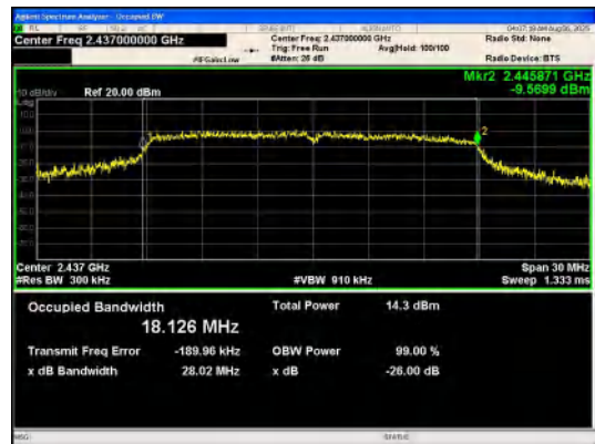
IEEE 802.11n_Channel 6_20MHz_Antenna 0
