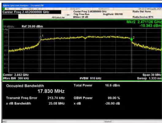
IEEE 802.11n_Channel 11_20MHz_Antenna 0
