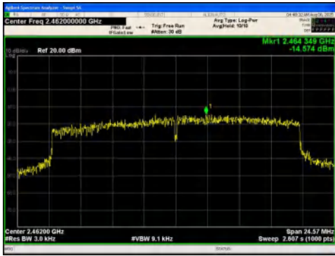
IEEE 802.11ax_Channel 11_20MHz_Antenna 0_RU&Index SU
