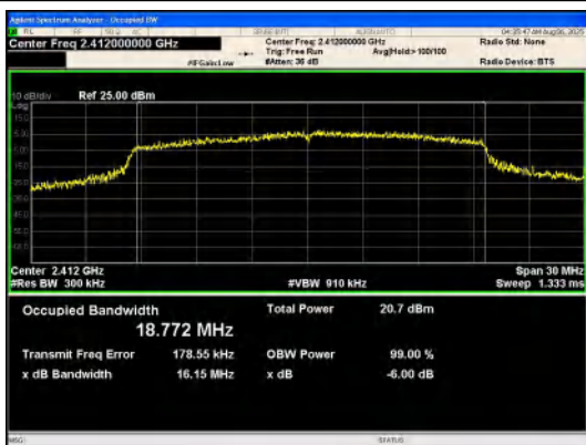
IEEE 802.11ax_Channel 1_20MHz_Antenna 0_RU&Index SU
