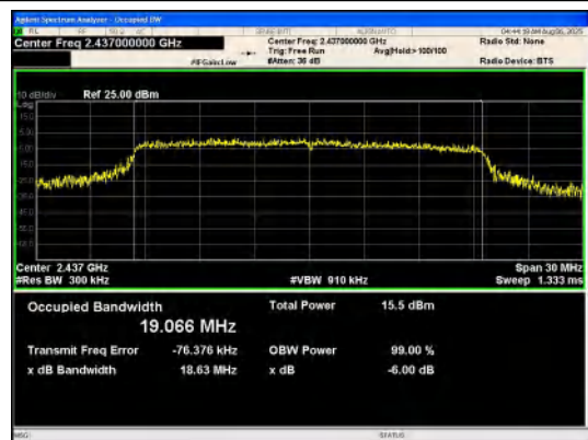
IEEE 802.11ax_Channel 6_20MHz_Antenna 0_RU&Index SU
