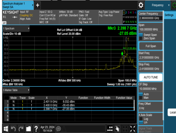
Band Edge BLE 1M HighCH39-2480MHz
