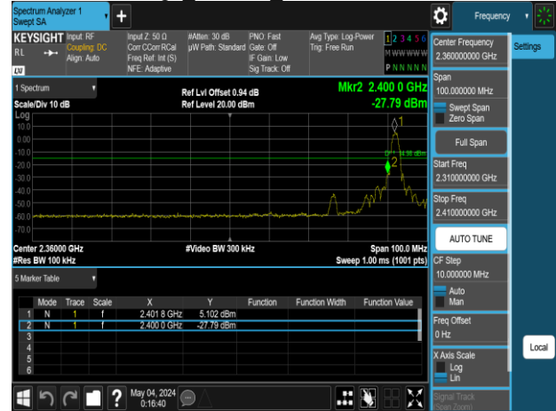
Band Edge BLE 2M HighCH39-2480MHz
