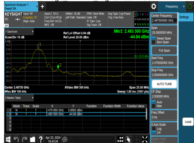
Band Edge BLE 2M HighCH39-2480MHz
