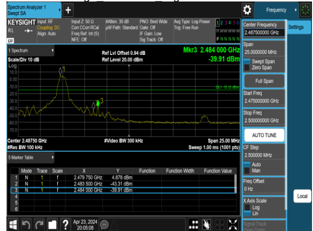
Band Edge BLE 500k HighCH39-2480MHz
