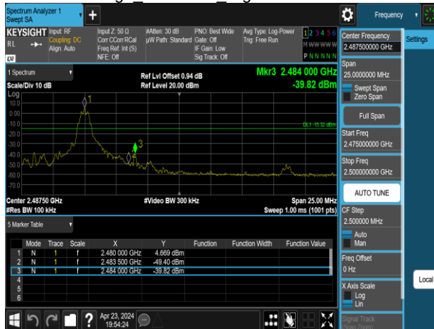
Band Edge BLE 125k HighCH39-2480MHz
