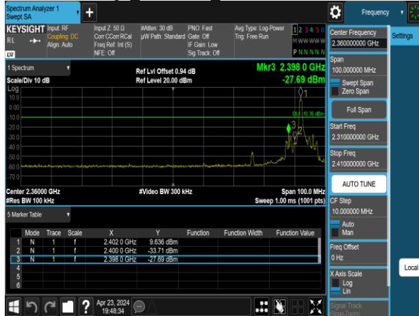
Band Edge BLE 125k HighCH39-2480MHz
