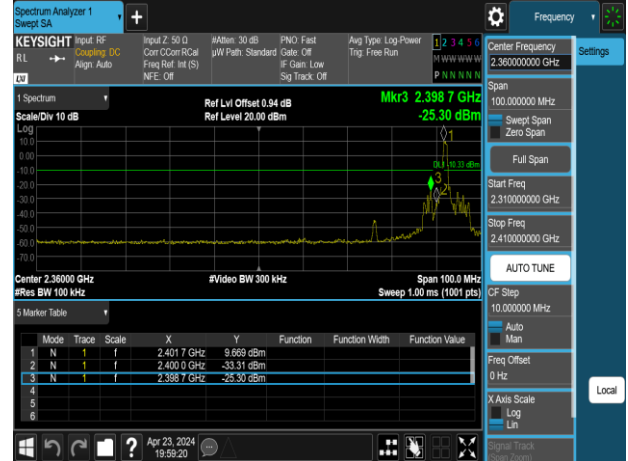
Band Edge BLE 500k HighCH39-2480MHz
