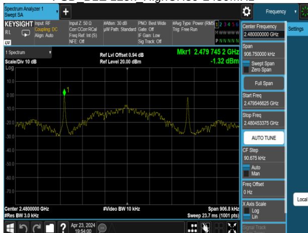
PSD BLE 125k HighCH39-2480MHz
