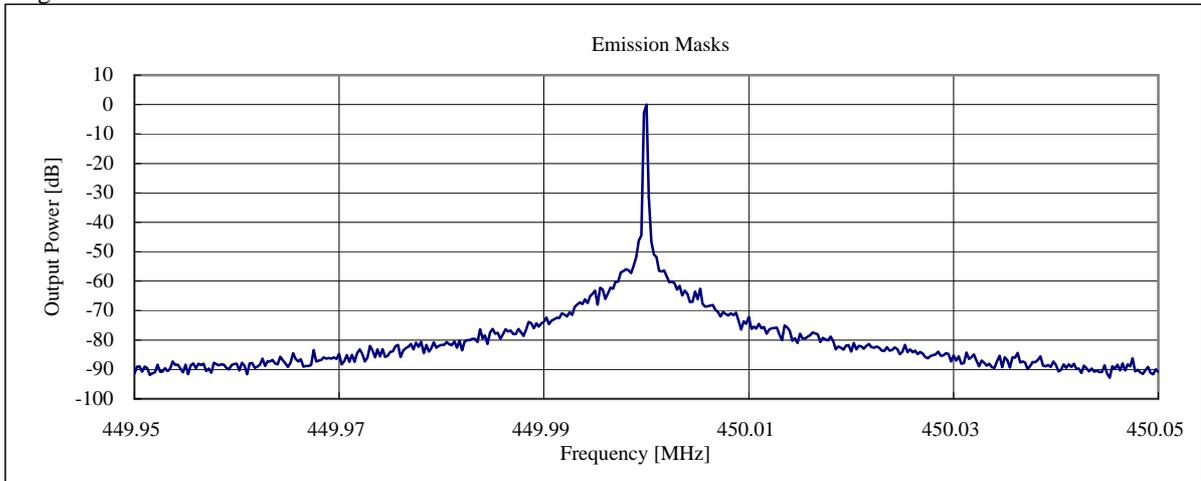
State : High Power / Narrow Band Modulation:FM / 450.00 MHz
