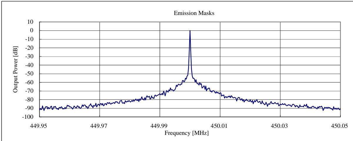
State : Low Power / Narrow Band Modulation:FM / 450.00 MHz
