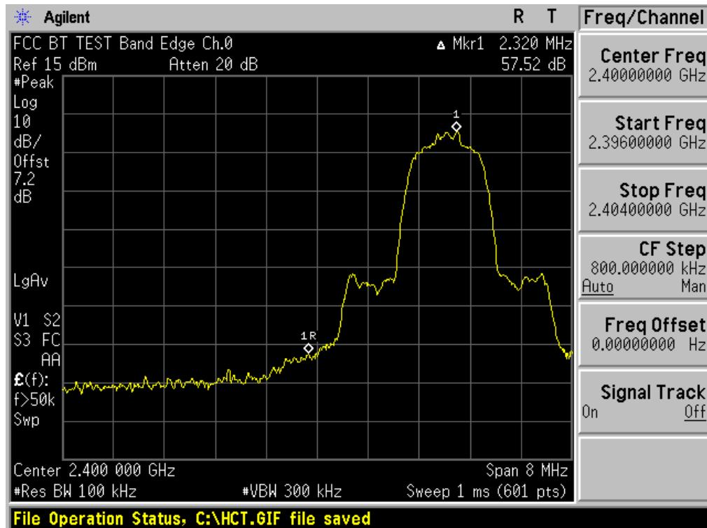
Test Plots without hopping ( $\pi/4$ DQPSK)
