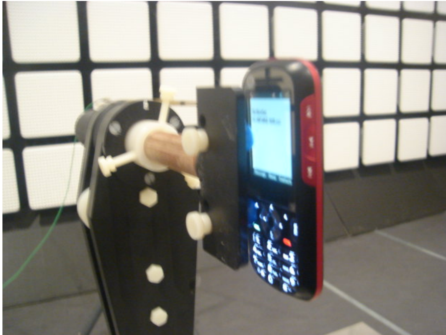
22946-1, IHDT56KY1 placed in test position Z
