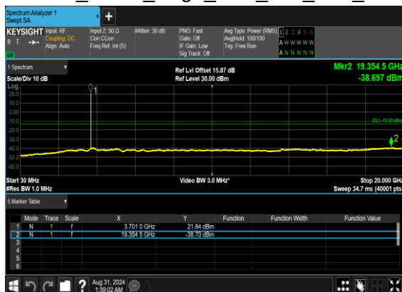
N77(10M)_DFT-s-OFDM BPSK Edge 1RB Left Low CH
