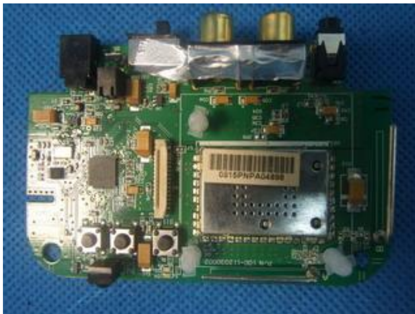
Fig. 4 – 80 RF Module top view
