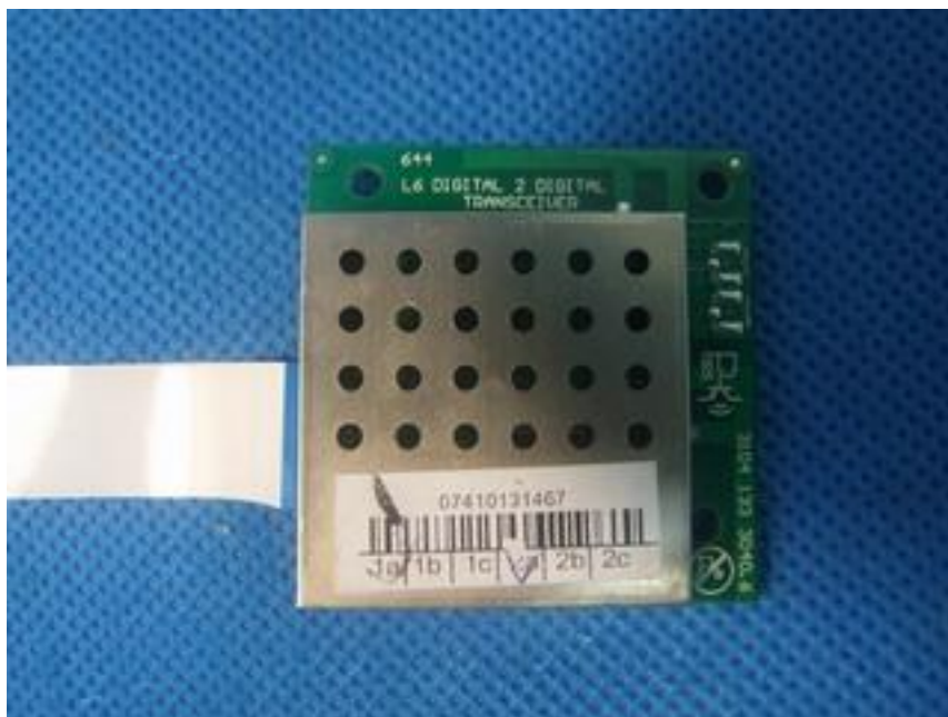
Fig. 4 – 79 RF Module top view
